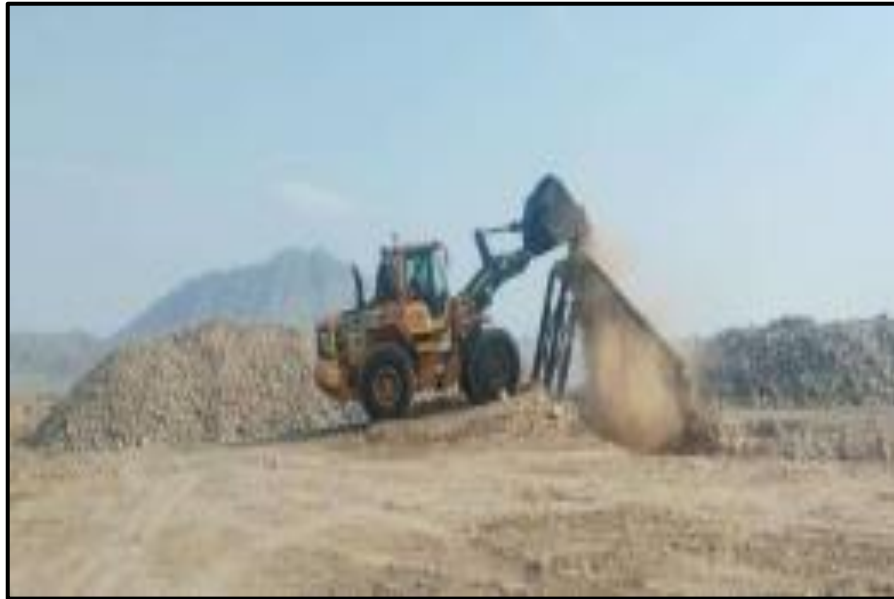
Figura N°17 Producción de material 4-2 y 4-3 en cantera
