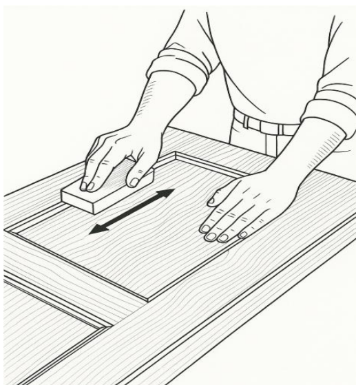
Figura 37. Técnica de lijado en dirección de la veta de la madera
