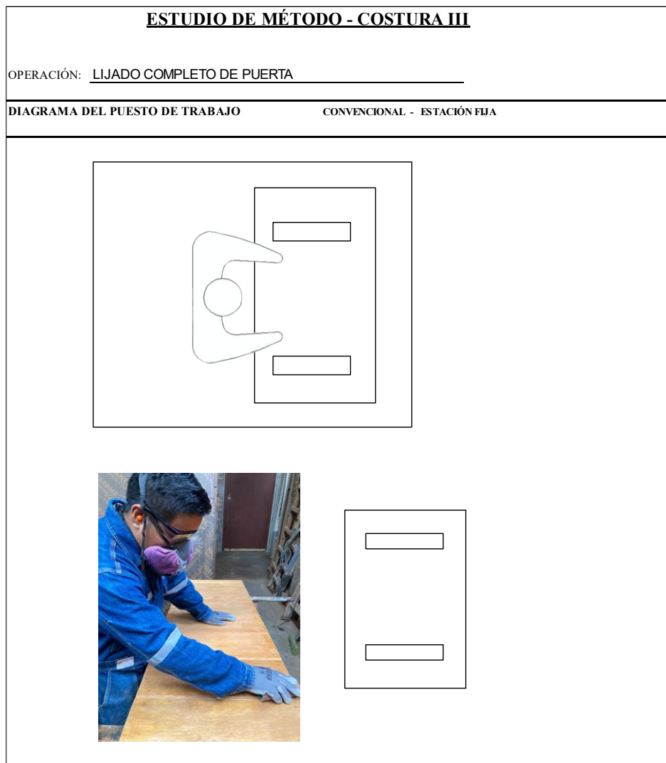
Figura 36. Método propuesto del lijado – Estación de trabajo
