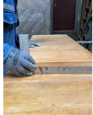
Figura 42. Inspección mediante escuadra
