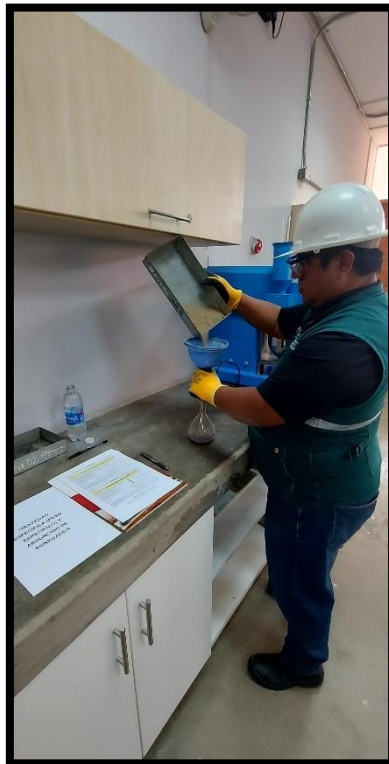
Pesando el picnómetro y vaciando el material en él.
