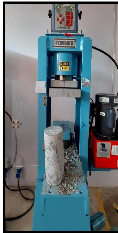
Preparativos para el ensayo de resistencia a la compresión de las probetas de concreto
