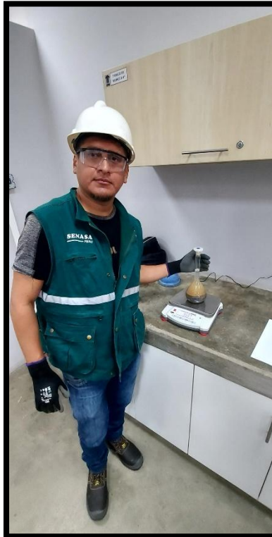
Pesando el picnómetro con material y agua.
