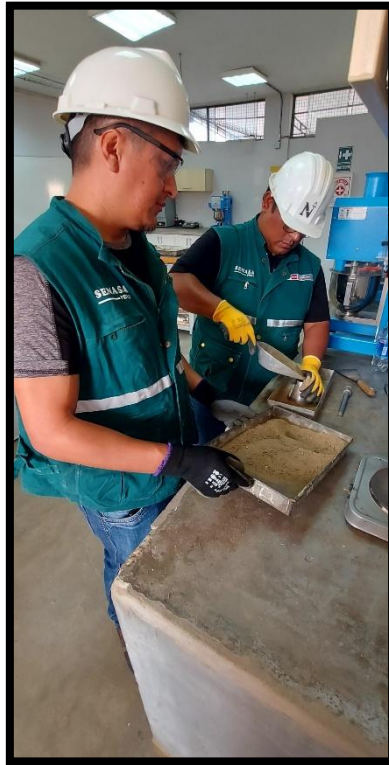
Secando el agregado fino en estufa y colocando en molde cónico para verificar su humedad superficial
