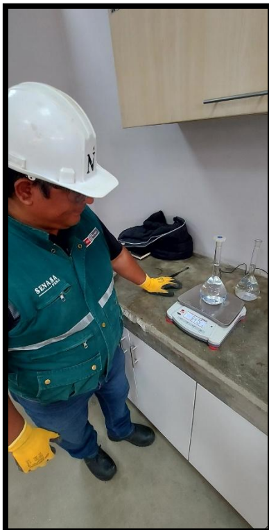
Pesando el picnómetro con agua y molde con muestra superficialmente seca
