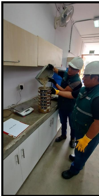
Pesando el agregado grueso y colocándolo en los tamices.
