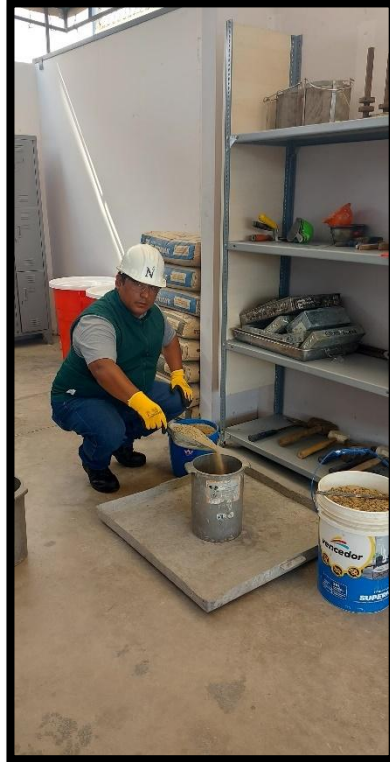
Colocando material en molde y enrasando
