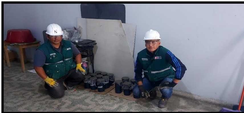
Colocando la mezcla dentro de los moldes y realizando la cobertura de la superficie con una capa de plástico
