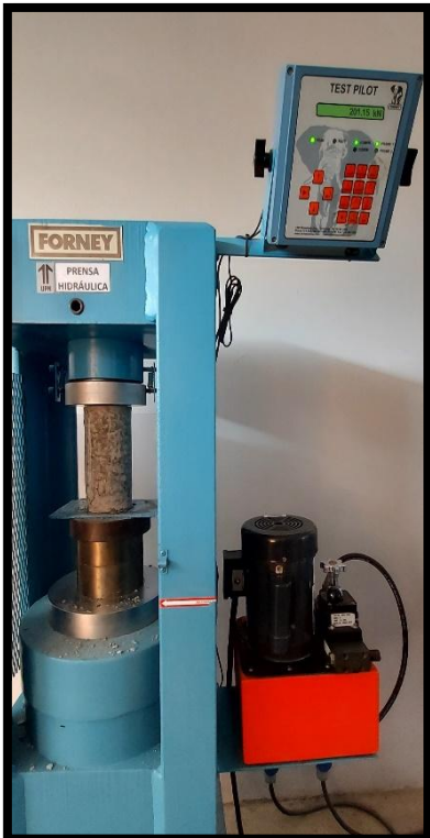
Tomando evidencias de las cargas últimas de rotura para cada probeta
