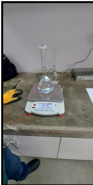
Pesando el picnómetro con agua y molde con muestra superficialmente seca
