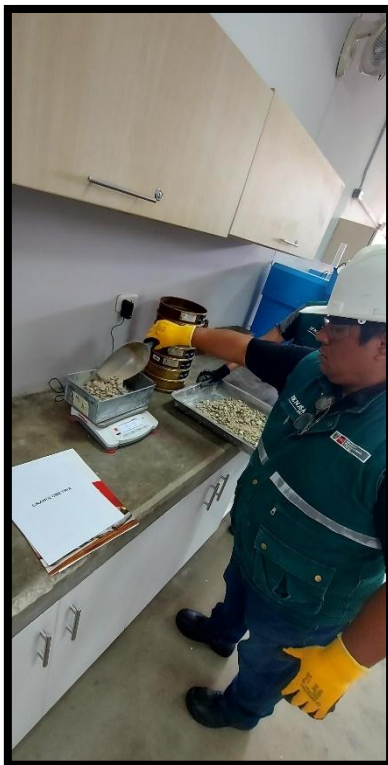
Pesando el agregado grueso y colocándolo en los tamices.
