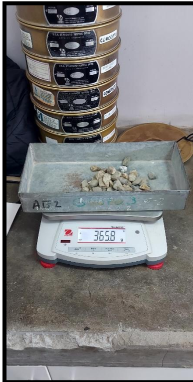
Pesando el material retenido en cada tamiz
