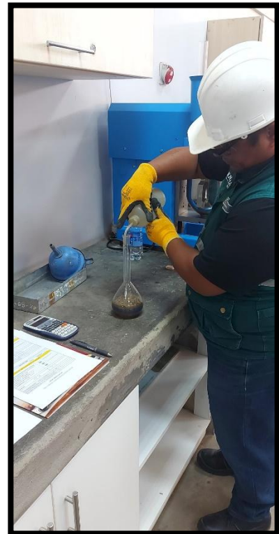
Pesando el picnómetro y vaciando el material en él.
