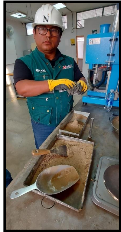
Secando el agregado fino en estufa y colocando en molde cónico para verificar su humedad superficial
