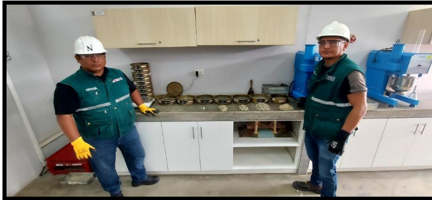
Pesando el material (agregado grueso) retenido en cada tamiz y material fino para ensayo de granulometría.
