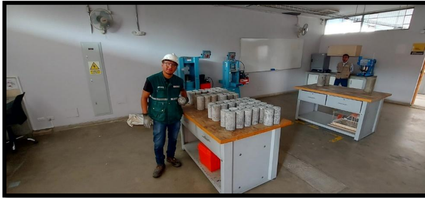
Preparativos para el ensayo de resistencia a la compresión de las probetas de concreto
