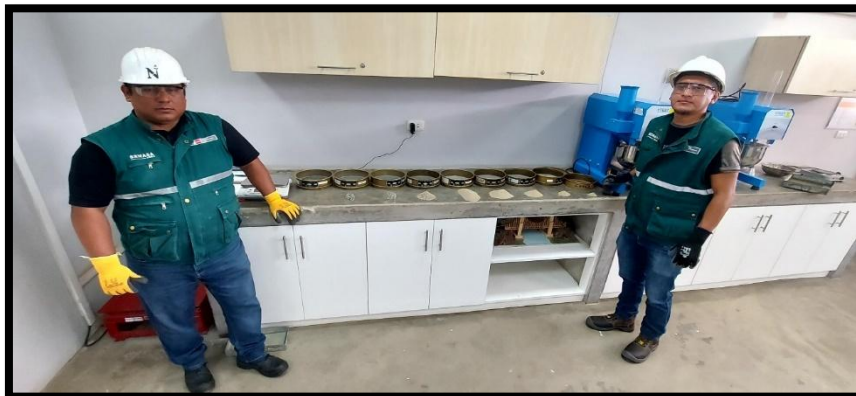
Mostrando las cantidades retenidas en cada tamiz para los agregados grueso y fino.
