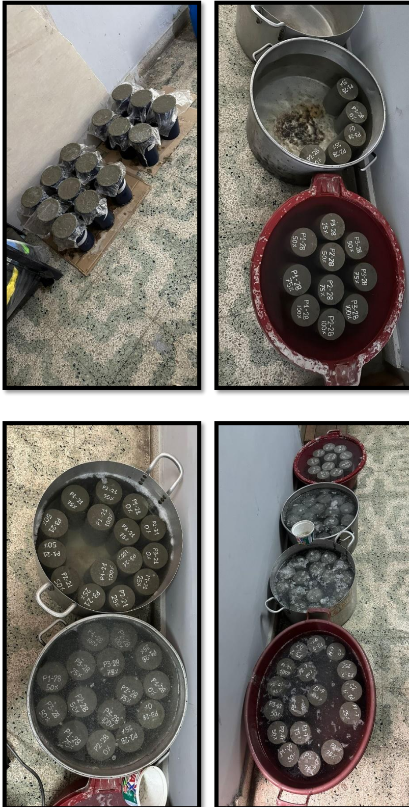
Curando las probetas de concreto elaboradas.
