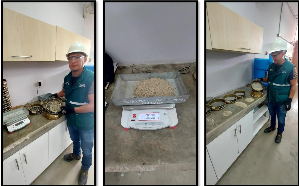
Pesando el material (agregado grueso) retenido en cada tamiz y material fino para ensayo de granulometría.
