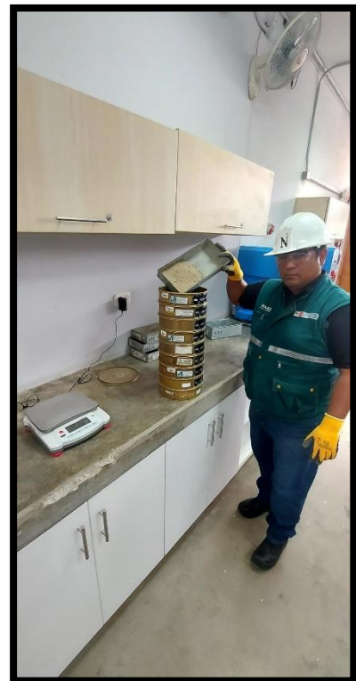
Pesando el agregado grueso y colocándolo en los tamices.
