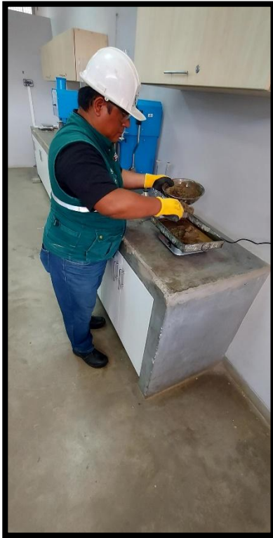
Secando el agregado fino en estufa y colocando en molde cónico para verificar su humedad superficial
