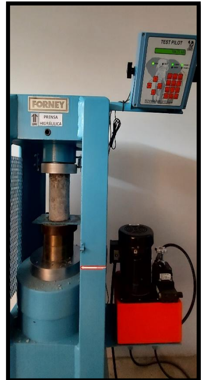
Tomando evidencias de las cargas últimas de rotura para cada probeta
