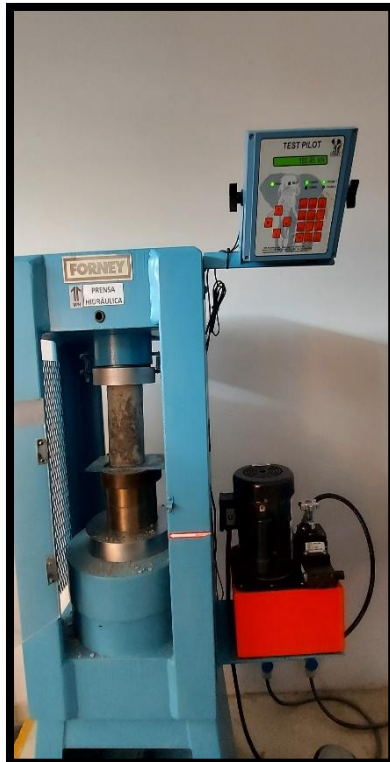
Tomando evidencias de las cargas últimas de rotura para cada probeta
