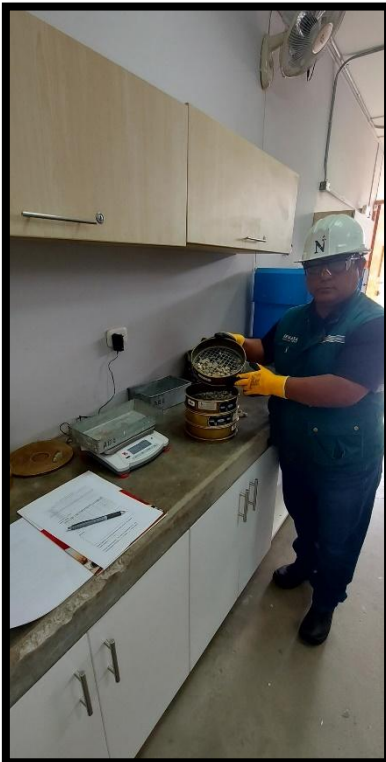
Agitando los tamices y pesando el molde a utilizar
