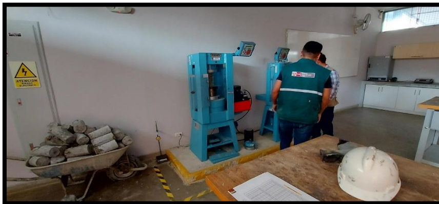
Realizando la rotura de las probetas en la prensa hidráulica
