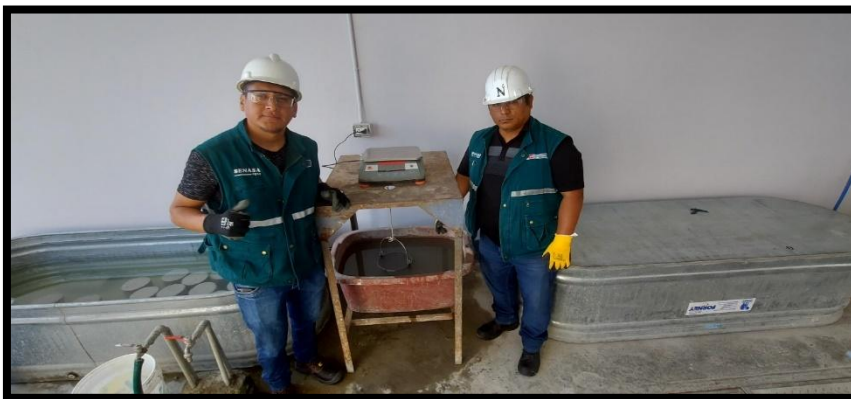
Secando la piedra superficialmente y cálculo del peso sumergido en agua,
