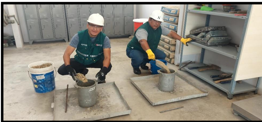
Colocando agregados grueso y fino dentro del molde
