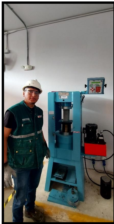
Preparativos para el ensayo de resistencia a la compresión de las probetas de concreto
