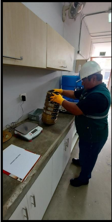
Agitando los tamices y pesando el molde a utilizar
