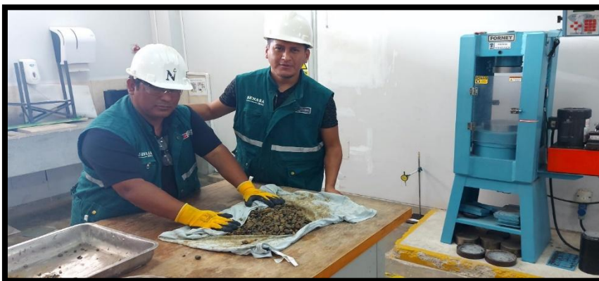
Tomando registro y colocando material en estufa por 24 horas.
