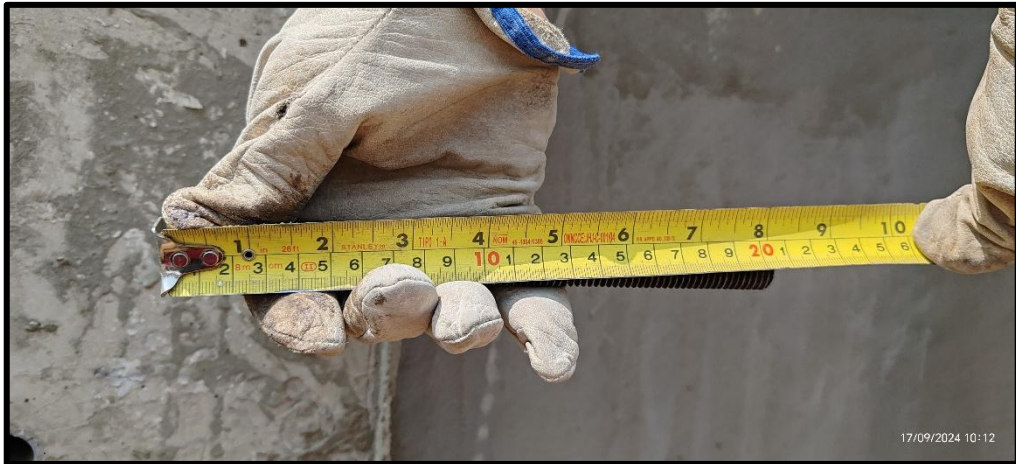
Figura N°23 Medida del anclaje del esparrago.
