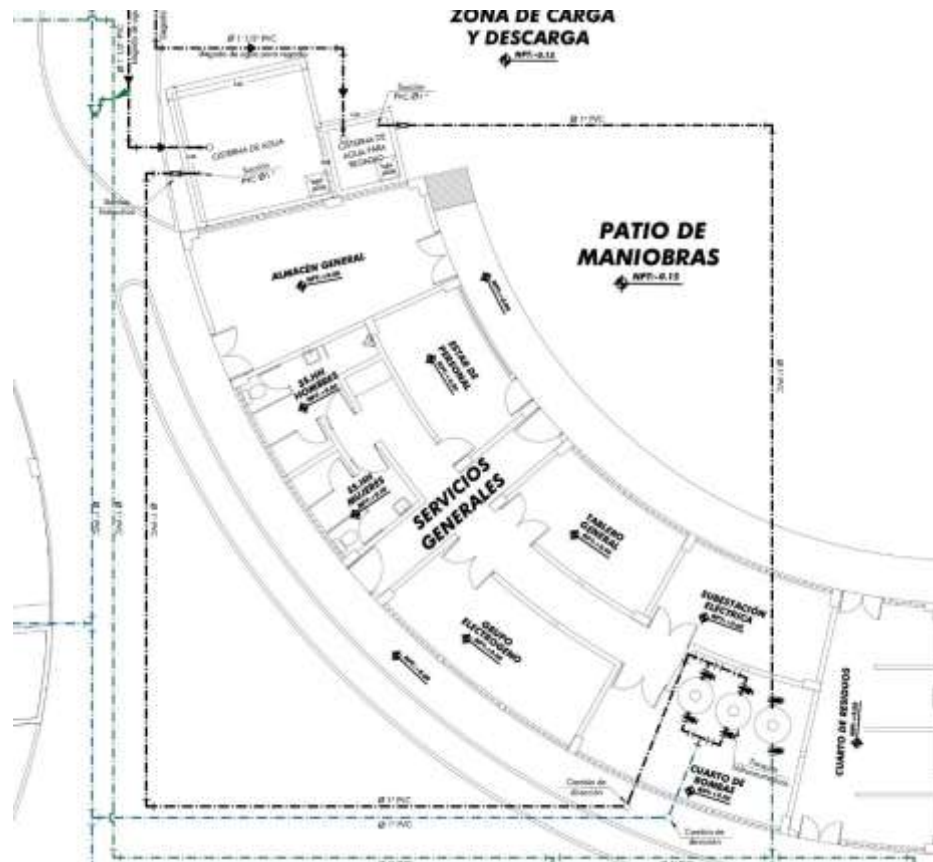
Imagen 02: Cisternas y bombas para agua potable y de riego
