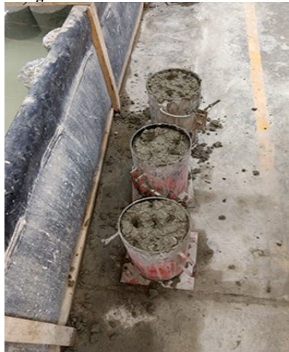
Fotografía N° 22. Elaboración de probetas.
