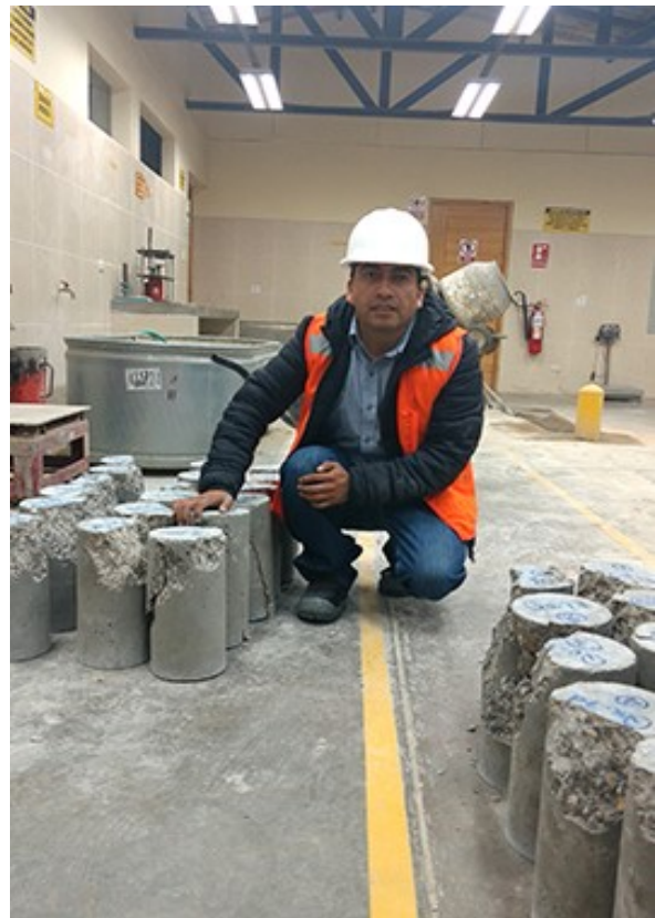
Fotografía N° 36. Probetas de concreto, luego de la realización del ensayo a la compresión.
