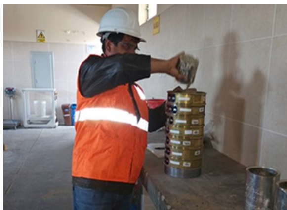
Fotografía N° 6. Tamizado del agregado grueso de cantera de río.
