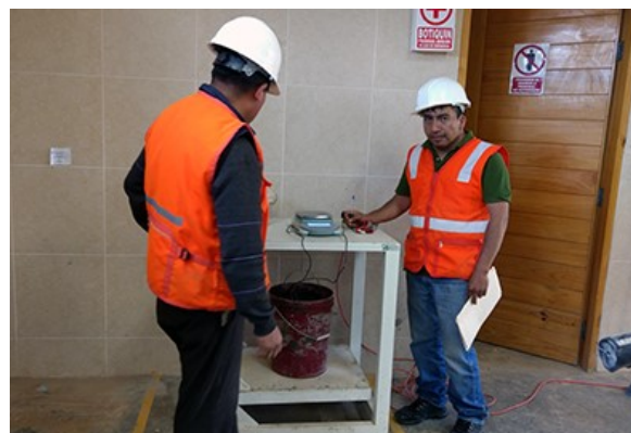
Fotografía N° 12. Peso específico del agregado grueso de cantera de río.
