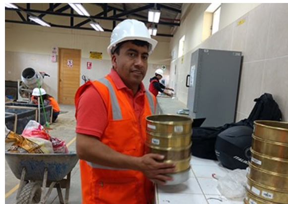
Fotografía N° 4. Tamizado del agregado fino de cantera de cerro.
