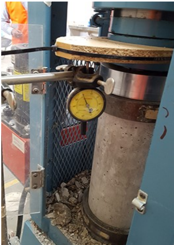
Fotografía N° 31. Realizando el ensayo a compresión de probetas de concreto
