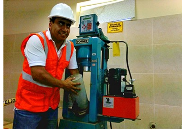
Fotografía N° 30. Realizando el ensayo a compresión de probetas de concreto.
