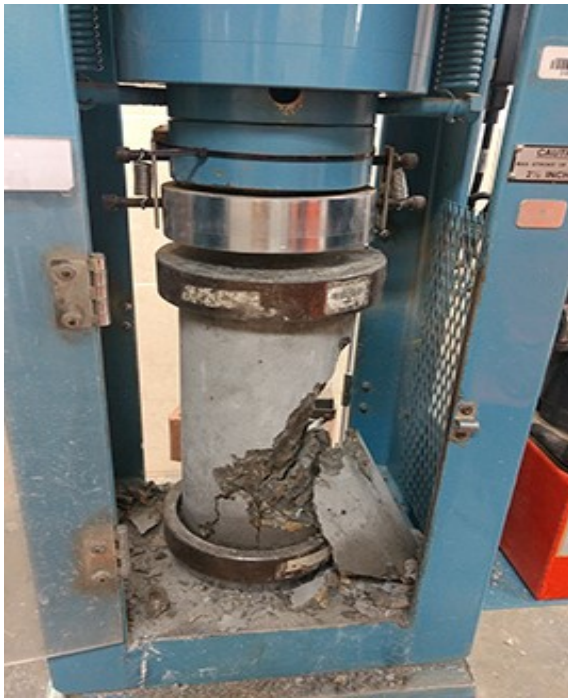
Fotografía N° 33. Falla tipo 4 de acuerdo a la Norma Técnica Peruana 339.034
