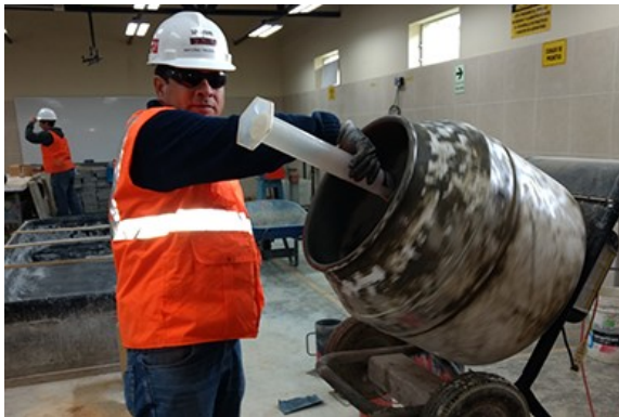
Fotografía N° 19. Mezclado de concreto.
