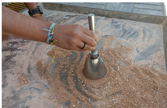
Fotografía N° 9. Ensayo del cono para luego determinar su gravedad específica del agregado fino de cantera de cerro.
