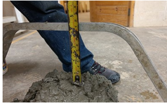
Fotografía N° 18. Asentamiento del concreto fresco del agregado de cantera de río.
