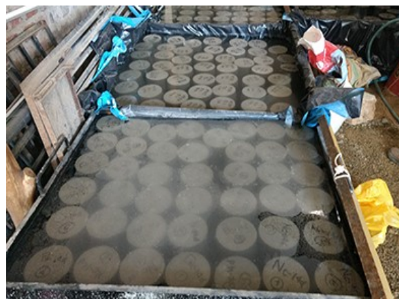
Fotografía N° 28. Curado de probetas de concreto
