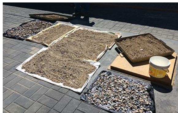
Fotografía N° 10. Agregado fino y grueso sss, para luego determinar la gravedad y peso específico respectivamente
