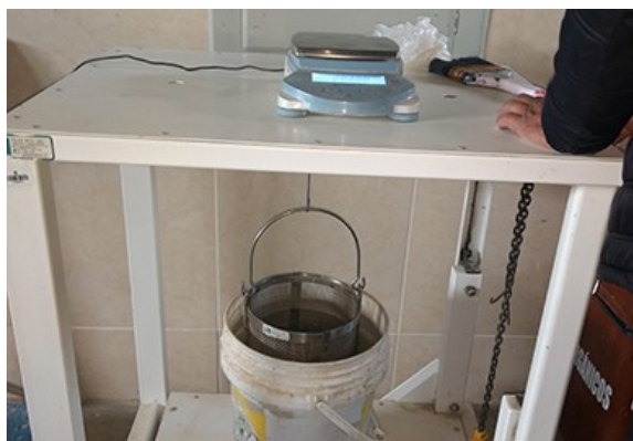
Fotografía N° 11. Peso específico del agregado grueso de cantera de cerro.
