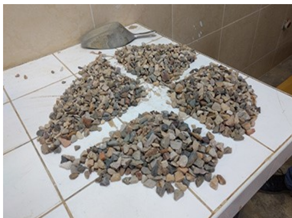
Fotografía N° 5. Método de cuarteo del agregado grueso de cantera de río.
