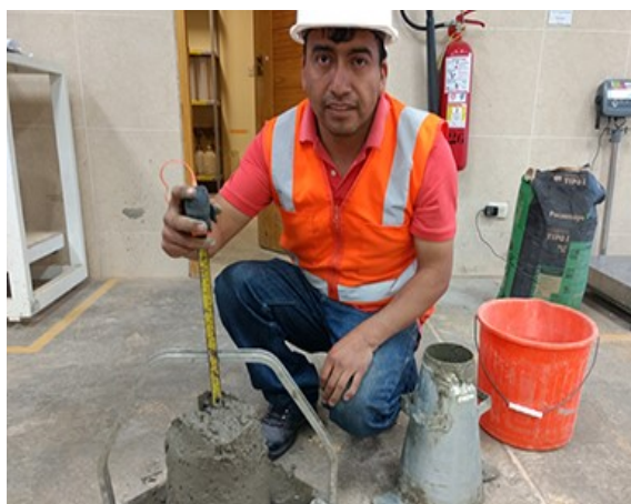
Fotografía N° 15. Midiendo el asentamiento del concreto fresco del agregado de cantera de cerro.
