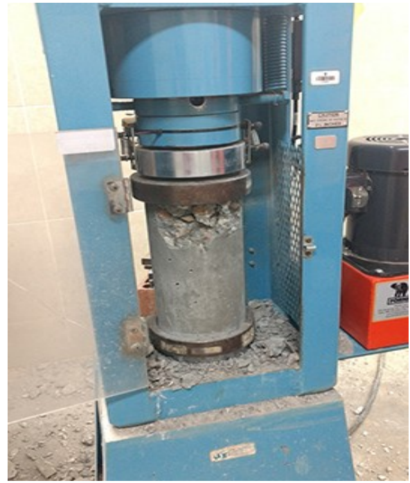
Fotografía N° 34. Falla tipo 5 de acuerdo a la Norma Técnica Peruana 339.034
