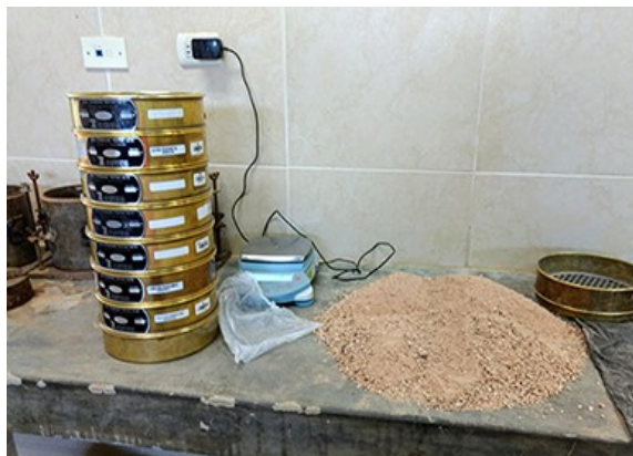
Fotografía N° 3. Método de cuarteo del agregado fino de cantera de cerro.
