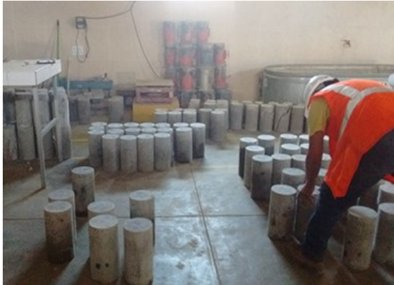
Fotografía N° 29. Midiendo el diámetro y altura de probetas para someterlos al ensayo a compresión.
