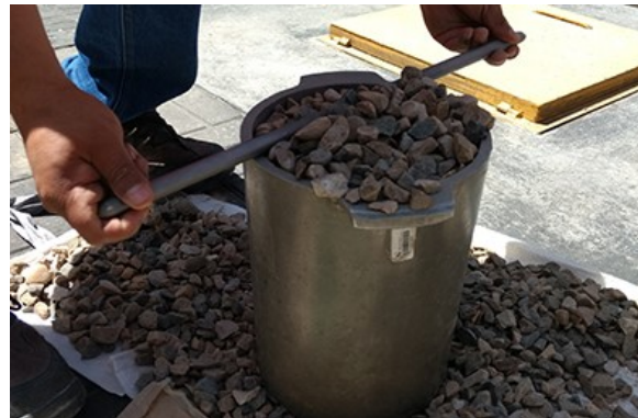
Fotografía N° 8. Peso unitario del agregado grueso de cantera de río.
