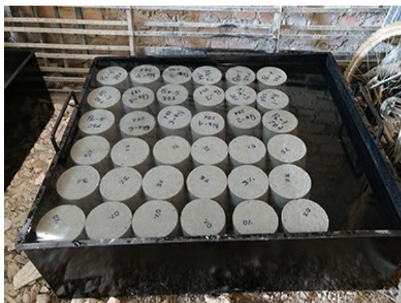
Fotografía N° 27. Curado de probetas de concreto
