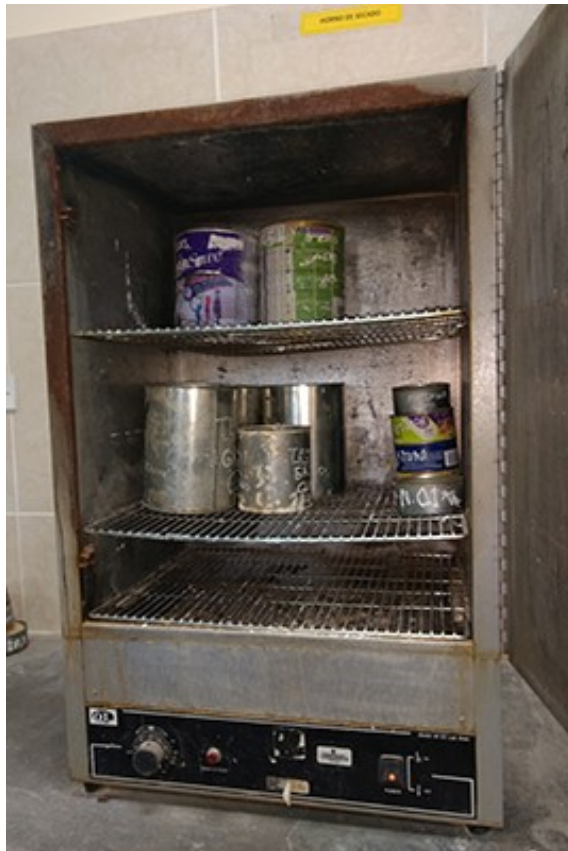
Fotografía N° 13. Secado en horno para sacar el contenido de humedad de los agregados de cerro.
