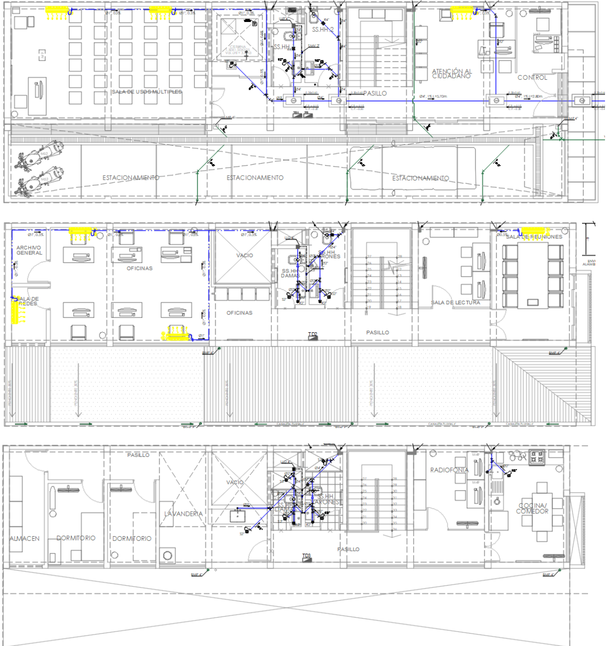
Figura 45. Redes de Desagüe
