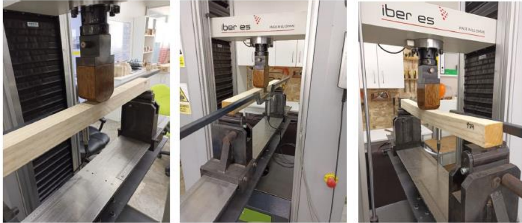
Anexo 1. Ensayos de flexión estática en muestras de madera
