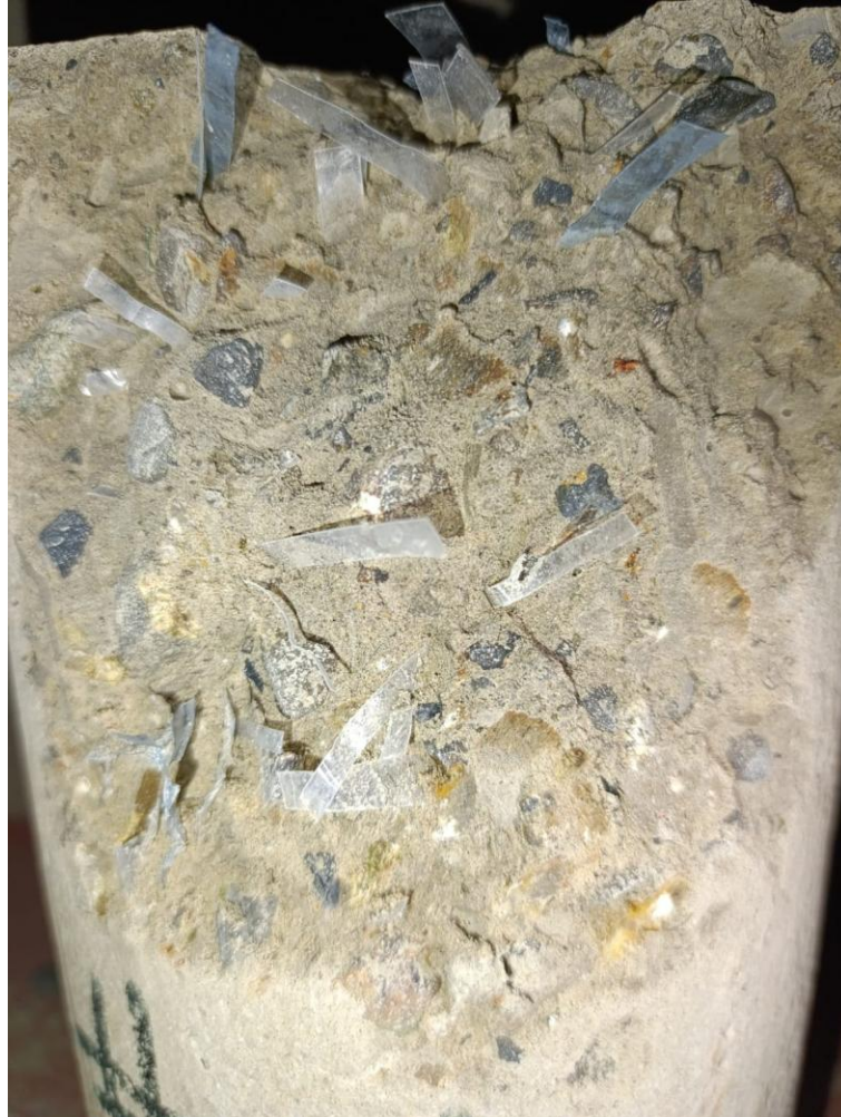
Imagen 03: Probeta con fibra de PET reciclado
