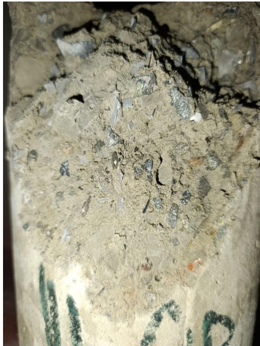
Imagen 02: Probeta con partículas de PET reciclado
