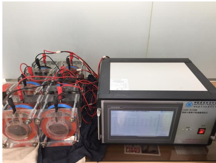
Figura 10: Espécimen listo para el ensayo de permeabilidad
