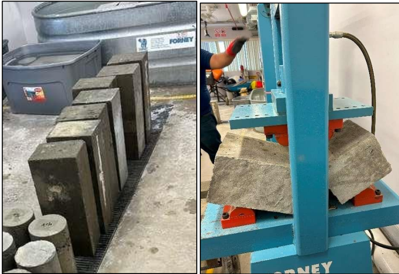
Rotura de vigas de concreto + 0.5 de VAR a los 7, 14 y 28 días
