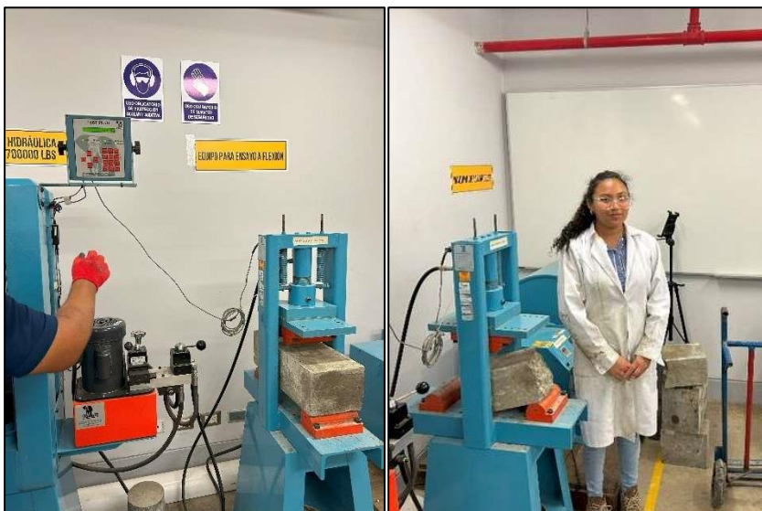
Rotura de vigas de concreto +1% de VAR a los 7, 14 y 28 días
