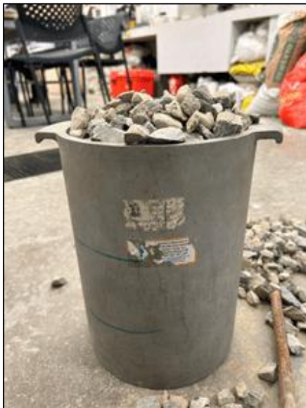
Figura 8 Ensayo de peso unitario suelto
