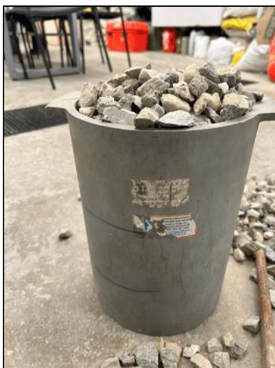
Figura 10 Ensayo de peso unitario compactado
