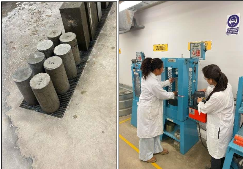
Rotura de cilindros de concreto patrón a los 7, 14 y 28 días
