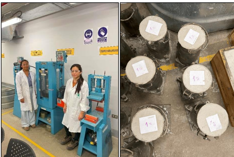
Rotura de cilindros de concreto + 0.5% de VAR a los 7, 14 y 28 días
