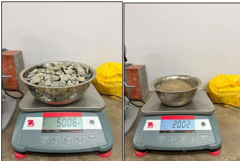
Figura 5 Cálculo del material retenido - Ensayo granulométrico
