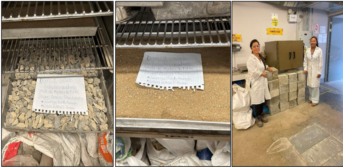
Figura 7 Secado de muestras - Ensayo peso unitario
