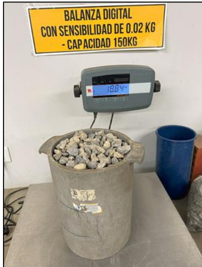
Figura 9 Medición del peso unitario suelto
