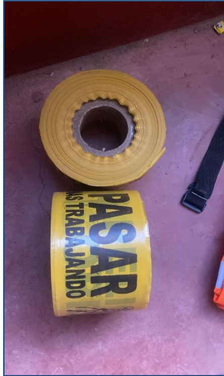
SE OBSERVA EL ROLLO DE CINTA DE PELIGRO ESENCIAL PARA DEMARCAR LAS ÁREAS DE TRABAJO
