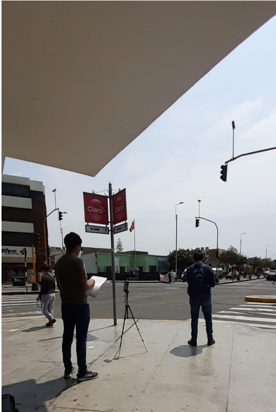
Fotografía 1. Medición del ruido
