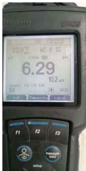
Medida del pH del agua residual después del tratamiento con PAC
