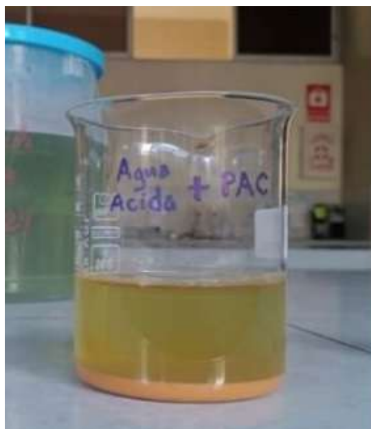
Muestra del agua residual con PAC
