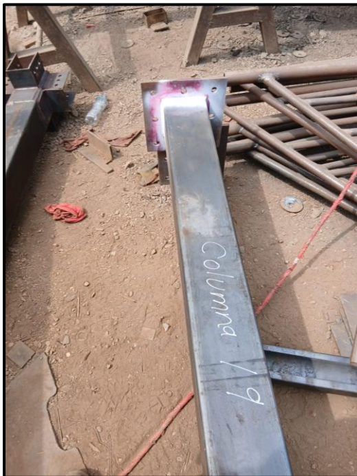
Figura 7: Control de soldadura con tintes penetrantes en columna tipo caja
