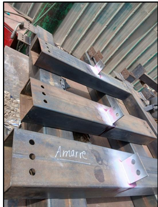
Figura 7: Control de soldadura con tintes penetrantes en columna tipo caja
