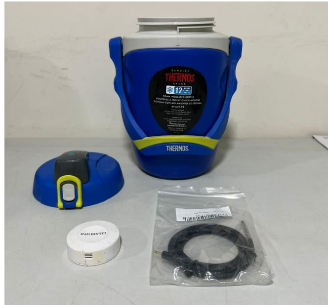
Fig.6 Instrumento para mediciones térmicas durante la hidratación temprana de mezclas hidráulicas cementosas (ASTM C1753-15)
