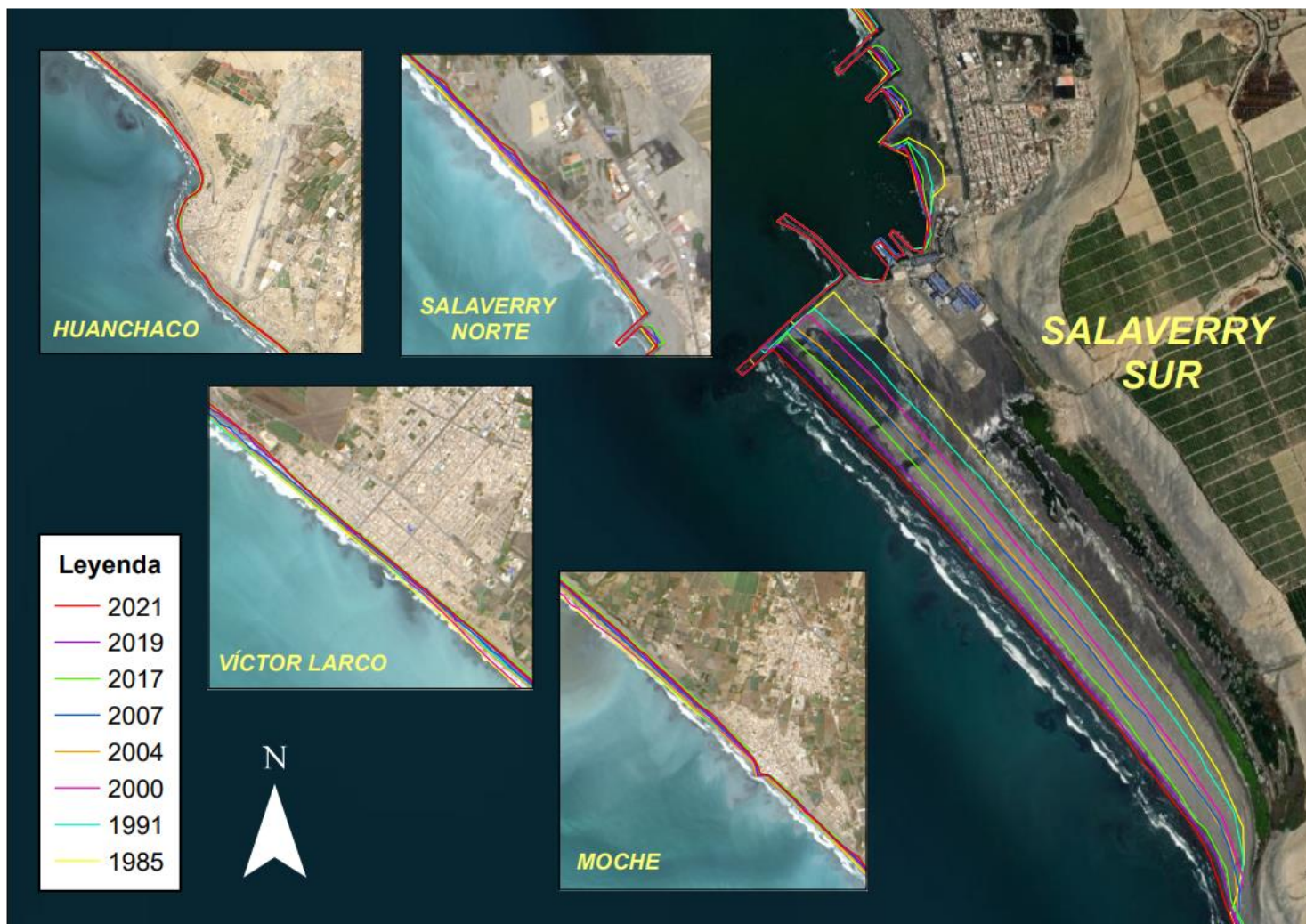
Fig. 8 Cambios de la línea de costa a causa del molón retenedor en el litoral de la ciudad de Trujillo.
