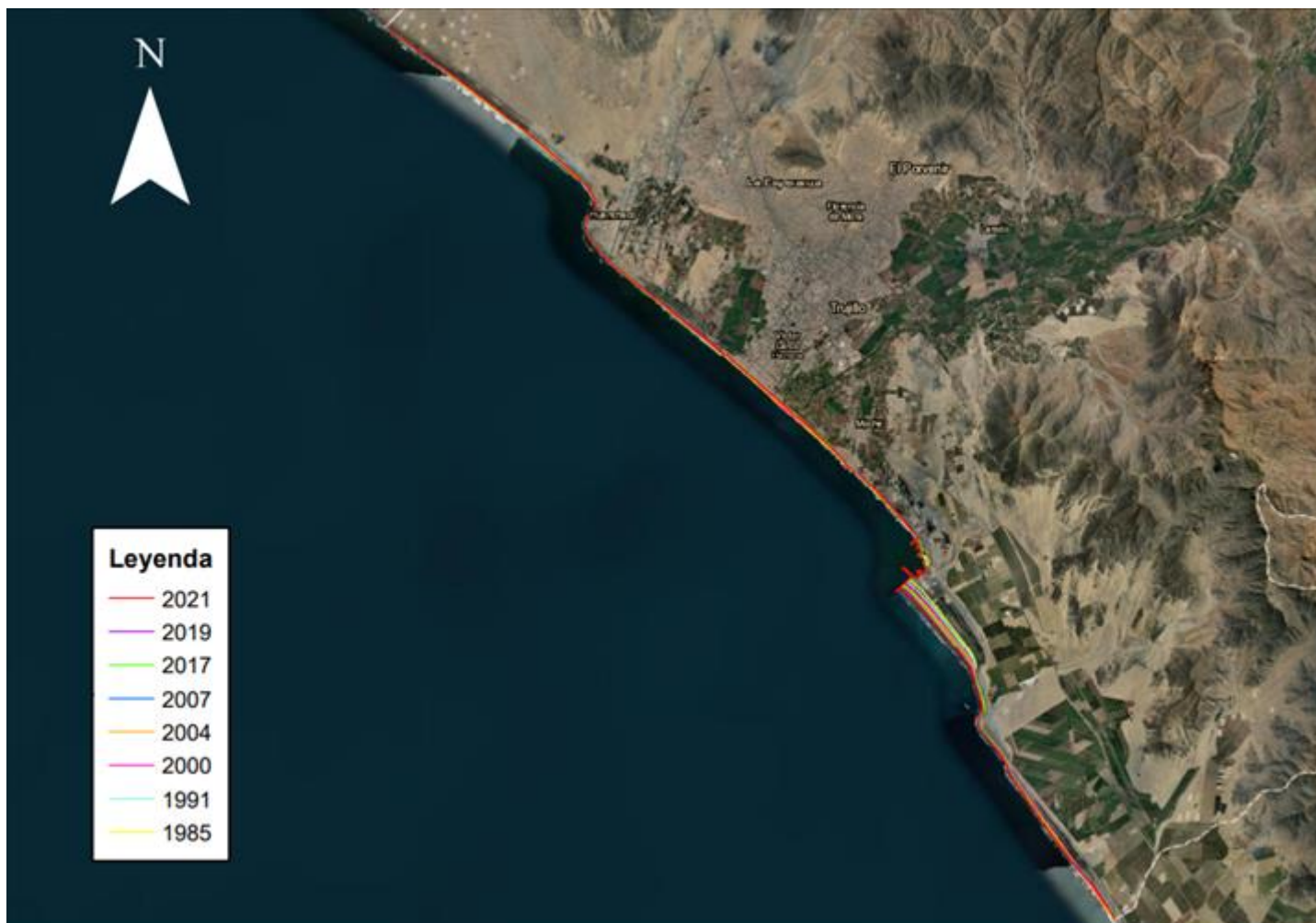
Fig. 2 Líneas costeras de los años 1985, 1991, 2000, 2004, 2007, 2017, 2019 y 2021 del litoral de la Ciudad de Trujillo.
