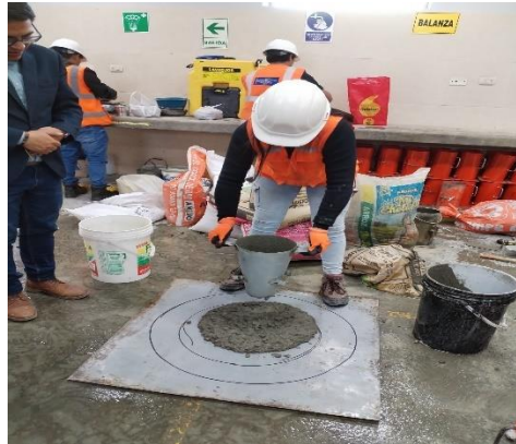
Fotografía Flujo de Cono Ensayo del embudo en V
