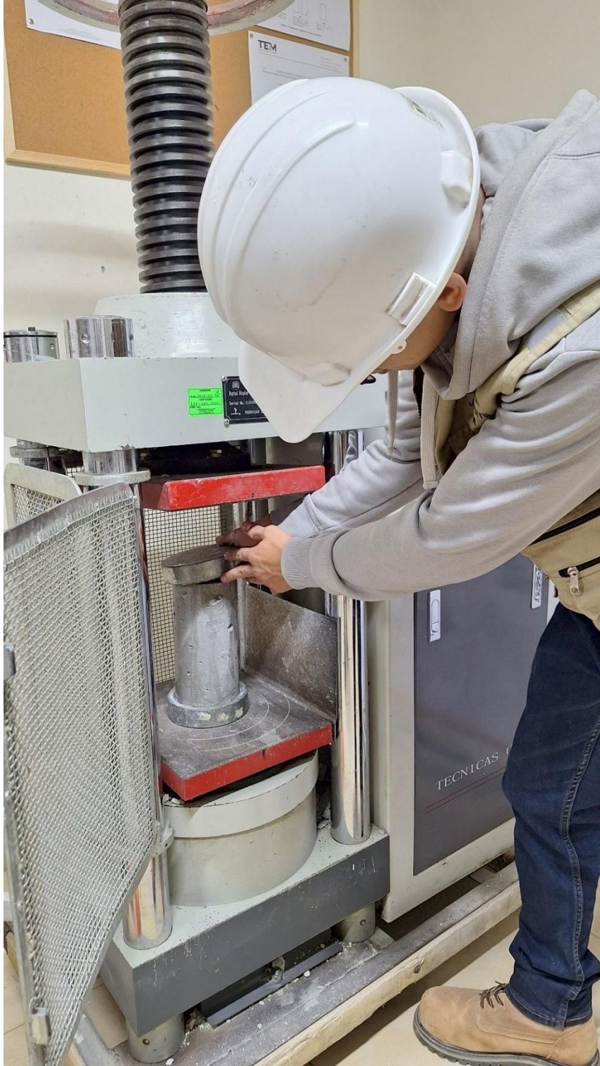
Figura 60: Compresión de probetas cilíndricas.
