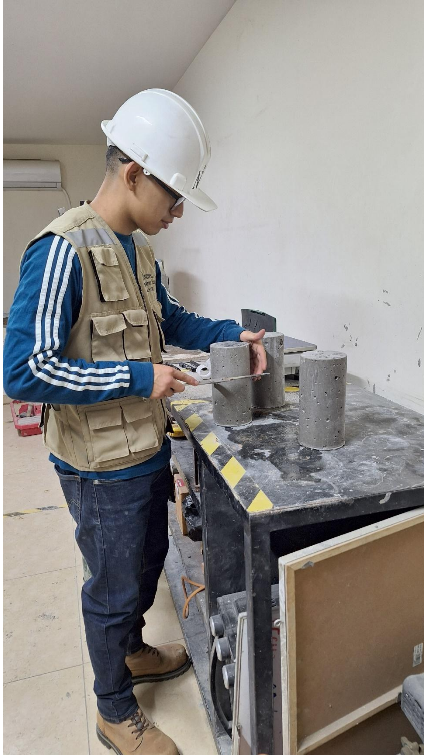
Figura 53: Toma de datos de muestras cilíndricas para ensayo (RC).
