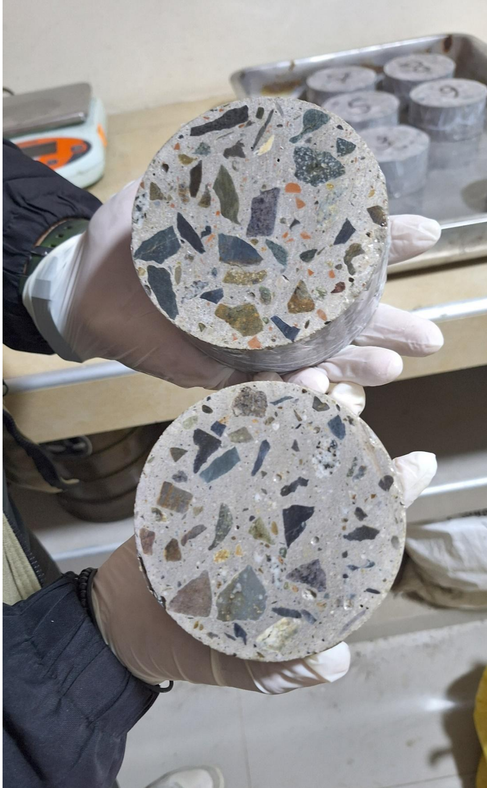
Figura 93: Muestra patrón y muestra con 8% de cerámica triturada.
