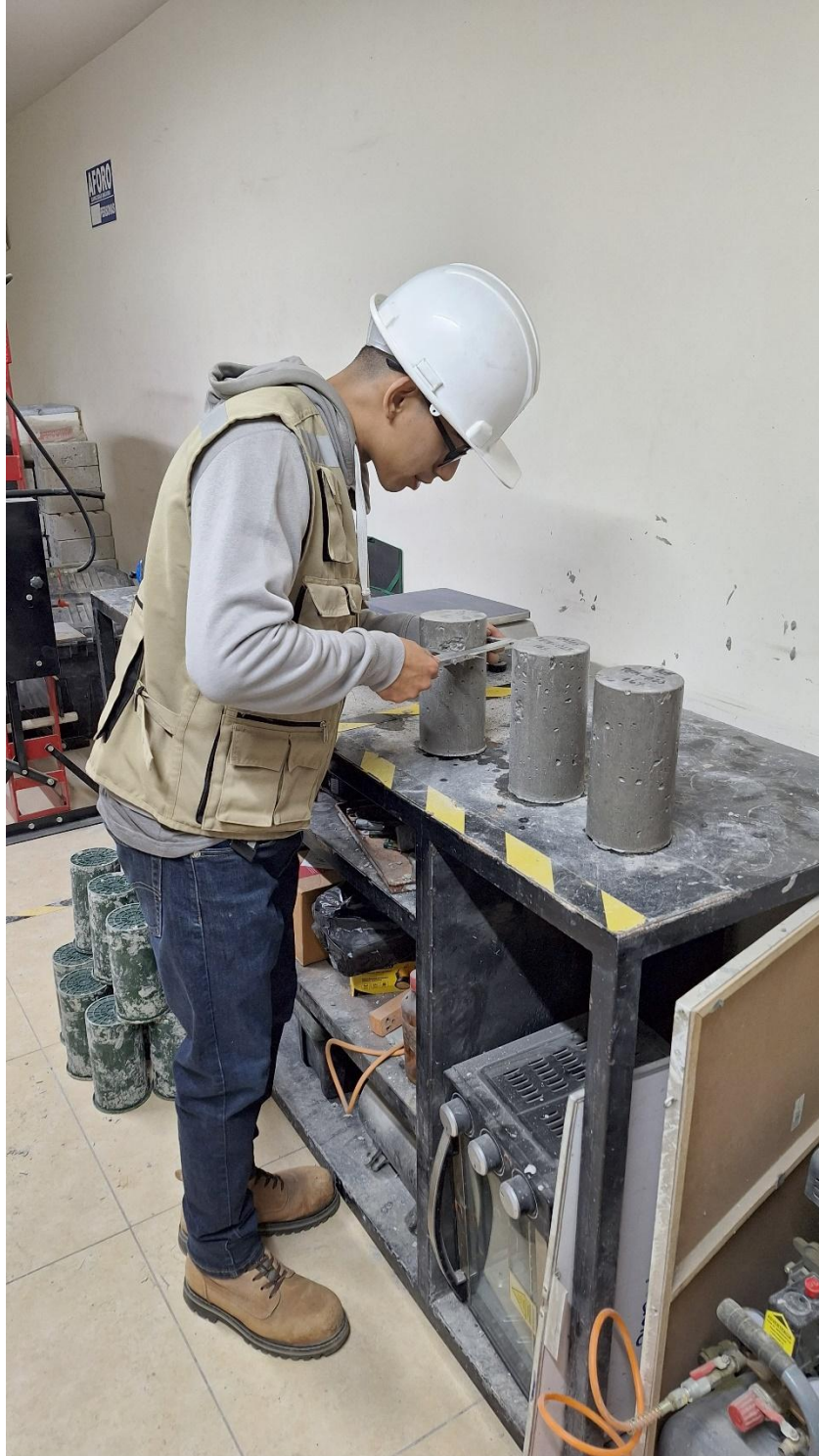
Figura 52: Toma de datos de muestras cilíndricas para ensayo (RC).
