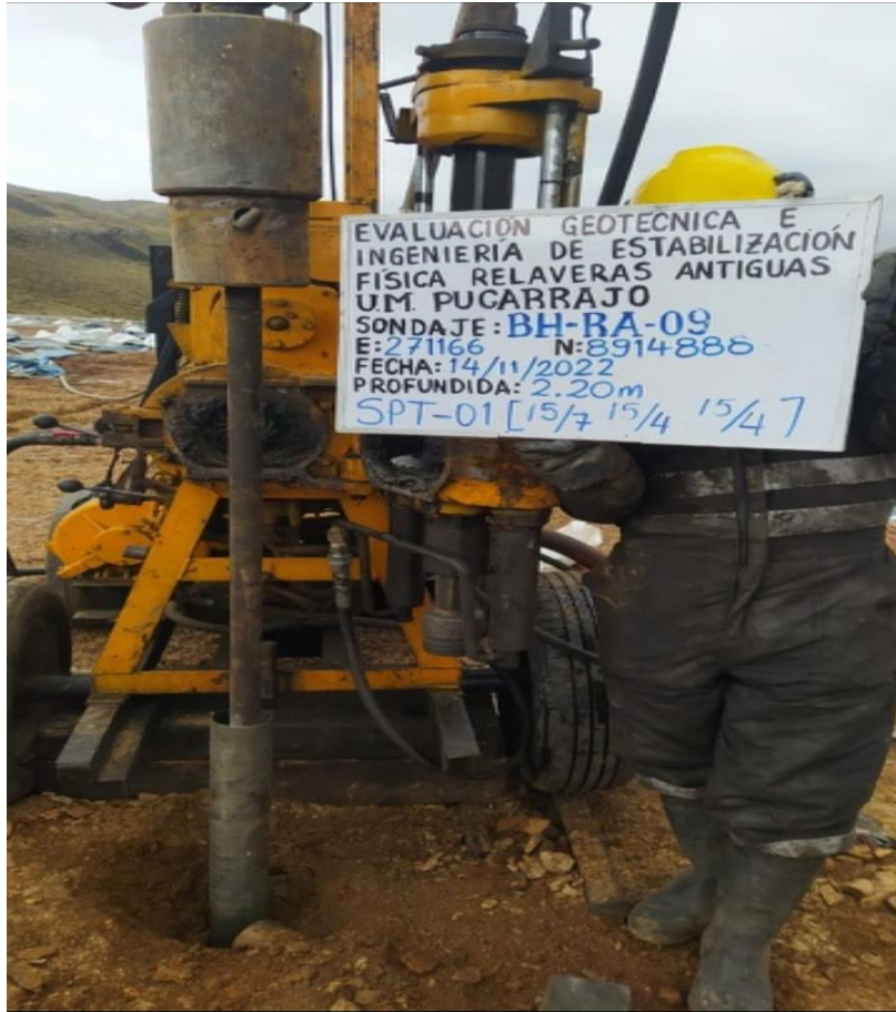
Foto N° 3: Ejecución de ensayo SPT y recuperación de muestra en tubo Shelby en BH-RA-09
