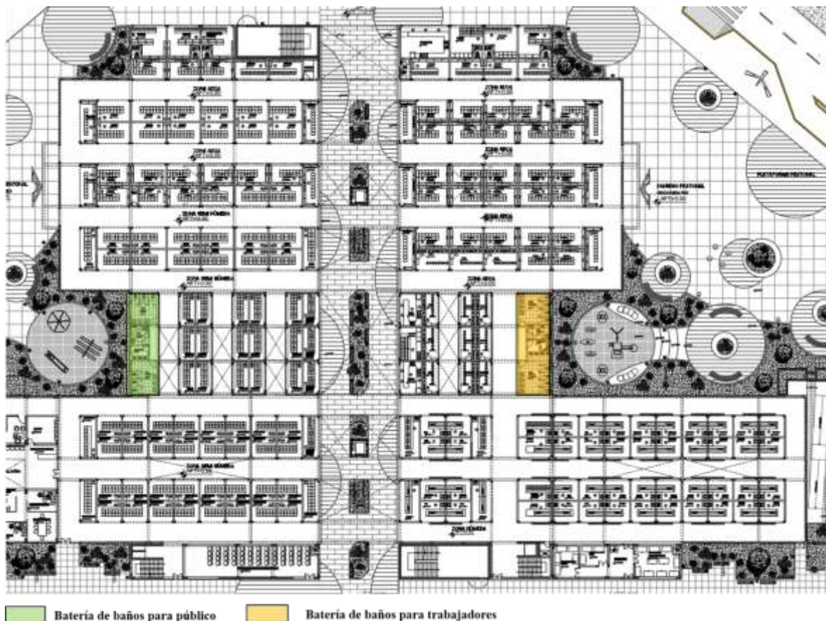
Figura 140. Batería de baños para público y trabajadores – Puestos de venta
