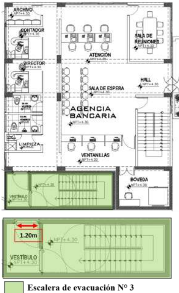
Figura 155. Escalera de evacuación N°3
