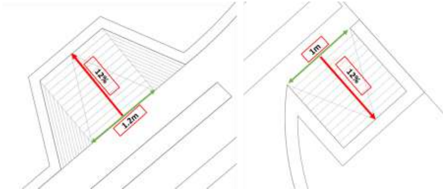
Figura 150. Rampa externa de 12%
