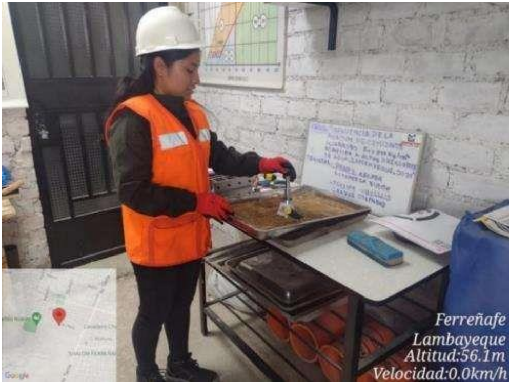
Fotografía N° 14: llenado de 3 capas de agregado fino, 25 golpes con pisón, ensayo de peso específico en agregado fino.
