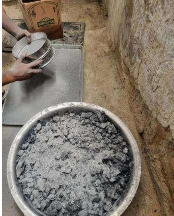
Fotografía N° 6: Tamizado de ceniza de algarrobo usando el tamiz N°100
