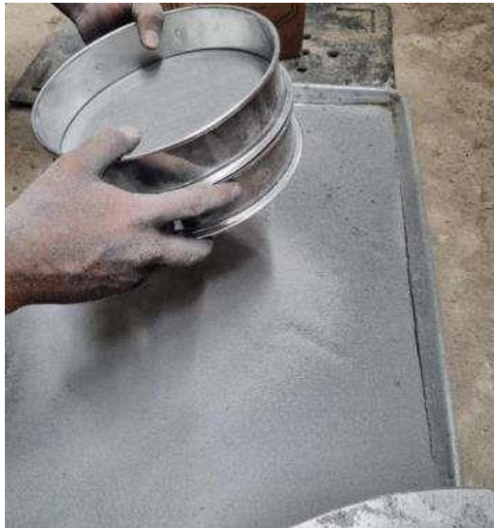
Fotografía N° 6: Tamizado de ceniza de algarrobo usando el tamiz N°100
