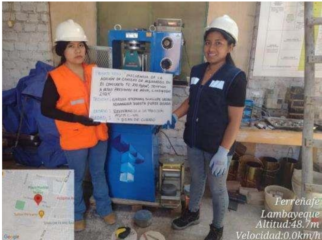
Fotografía N° 48: ensayo a Tracción por compresión diametral, edad 7 días, patrón
