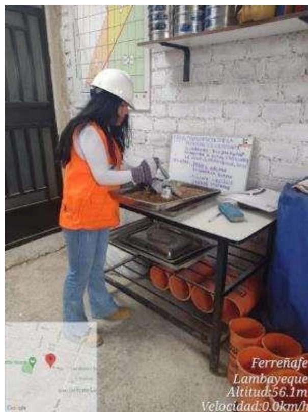
Fotografía N° 14: llenado de 3 capas de agregado fino, 25 golpes con pisón, ensayo de peso específico en agregado fino.
