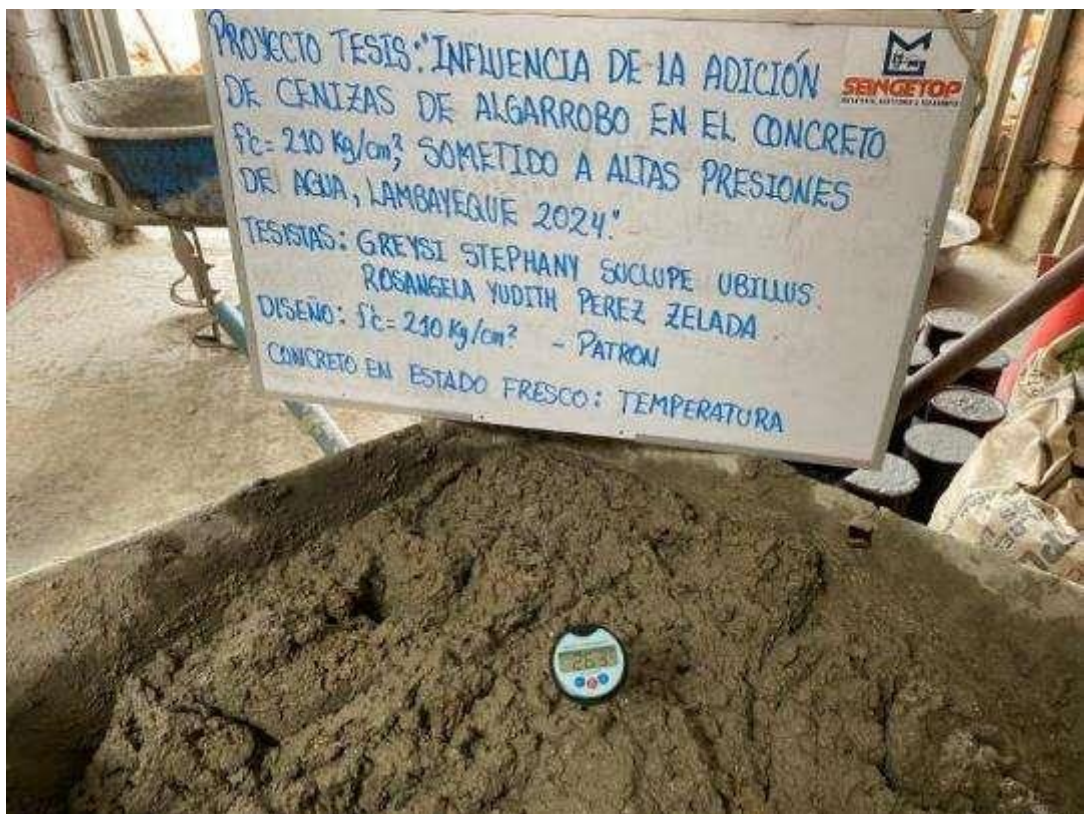
Fotografía N° 30: temperatura del concreto fresco.
