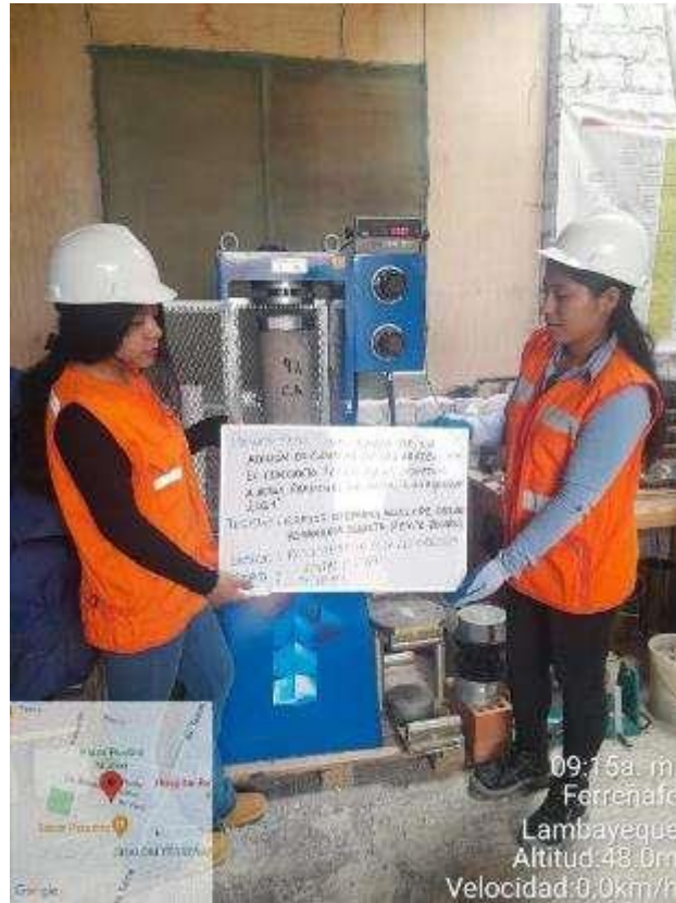
Fotografía N° 33: tipo de rotura 5 en el ensayo de compresión, edad 7 días con adición de 9% de ceniza de algarrobo.
