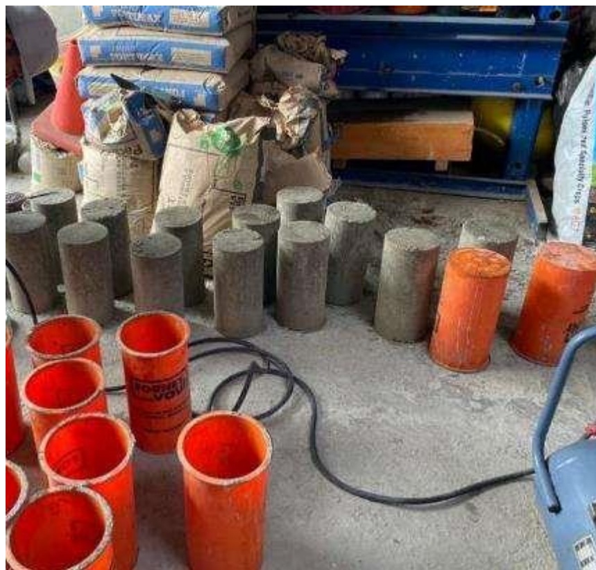
Fotografía N° 28: desencofrado de probetas con aditivo (ceniza de algarrobo) para el ensayo a compresión
