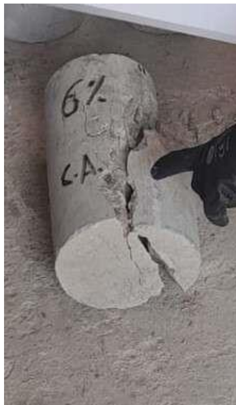
Fotografía N° 44: tipo de rotura 3 en el ensayo de compresión, edad 28 días con adición de 6% de ceniza de algarrobo.
