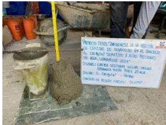
Imagen N° 5: Asentamiento-ensayo en el cono de Abrams concreto patrón
