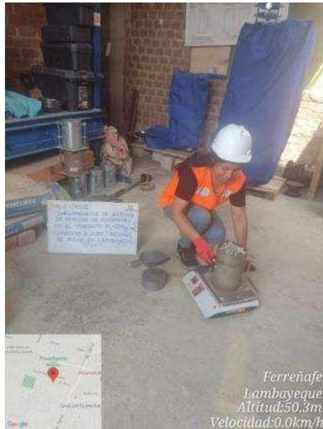
Fotografía N° 24: peso unitario suelto del agregado grueso
