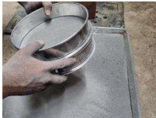
Imagen N° 2: tamizado de ceniza por malla N°200.
