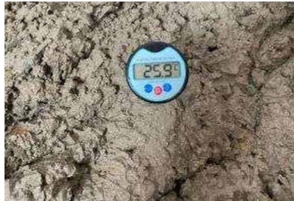
Imagen N° 8: Temperatura del concreto con adición de 12% C. A
