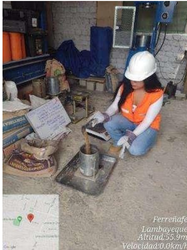
Fotografía N° 22: Apisonar con 25 golpes con la ayuda de una varilla en tres capas, peso unitario compactado del Agregado Fino
