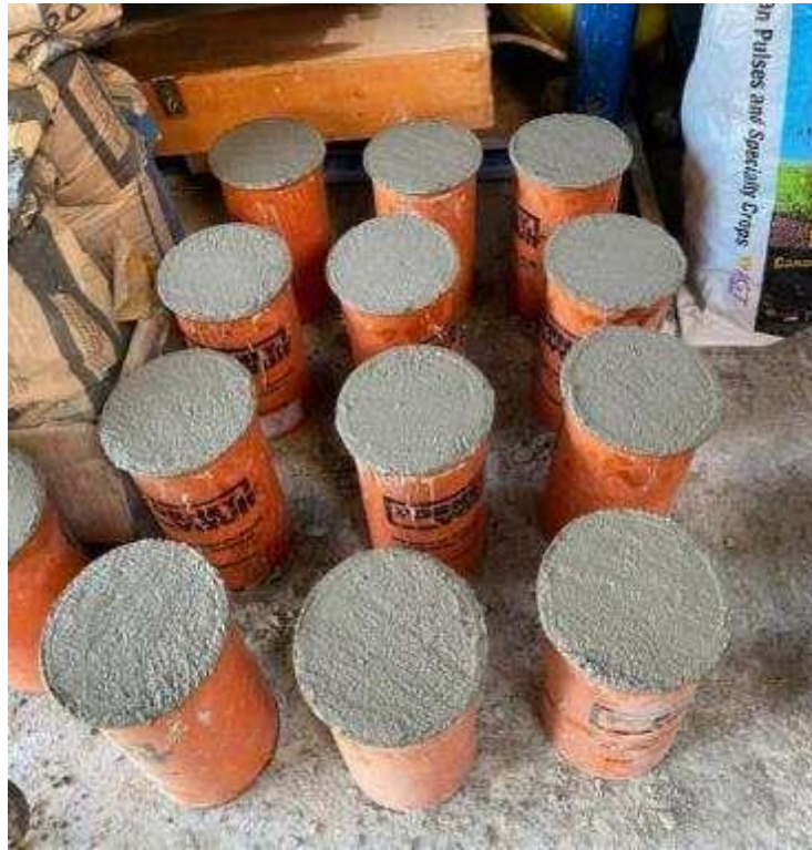
Fotografía N° 28: desencofrado de probetas con aditivo (ceniza de algarrobo) para el ensayo a compresión
