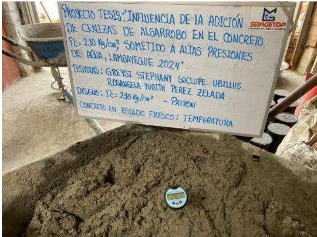
Fotografía N° 30: temperatura del concreto fresco.
