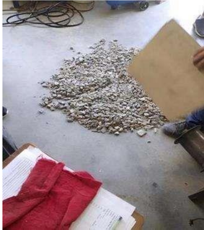
Fotografía N° 24: peso unitario suelto del agregado grueso
