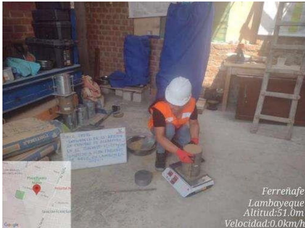
Fotografía N° 22: Apisonar con 25 golpes con la ayuda de una varilla en tres capas, peso unitario compactado del Agregado Fino
