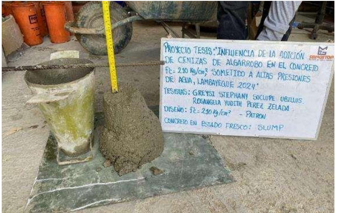
Fotografía N° 29: asentamiento del concreto en estado fresco (SLUMP)
