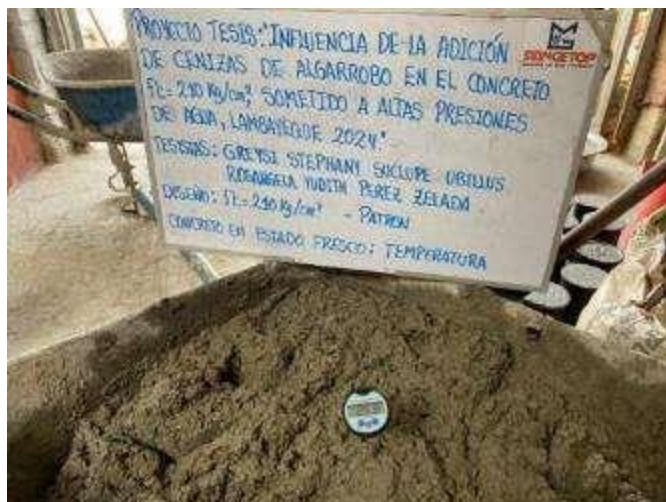
Imagen N° 6: Temperatura del concreto patrón
