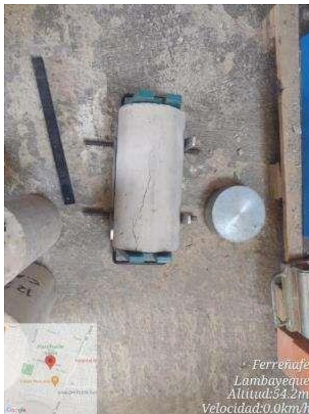
Fotografía N° 48: ensayo a Tracción por compresión diametral, edad 7 días, patrón
