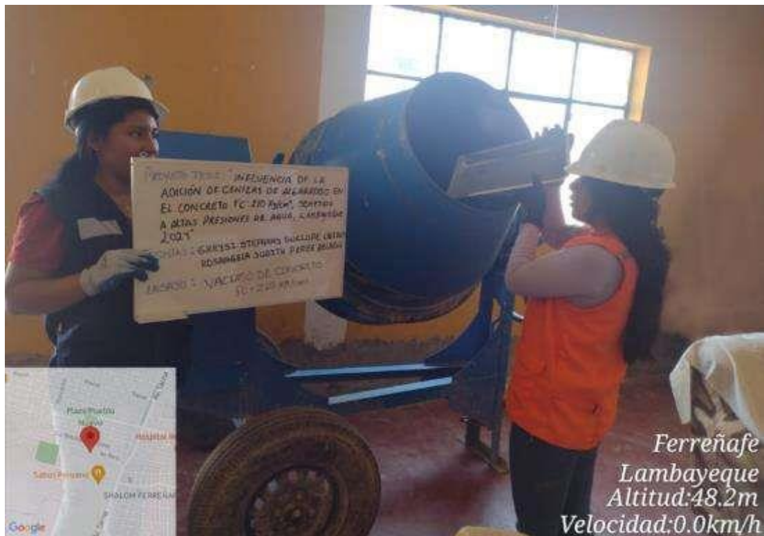
Fotografía N° 26: Mezclado de los materiales adicionando la ceniza de algarrobo para el diseño de concreto
