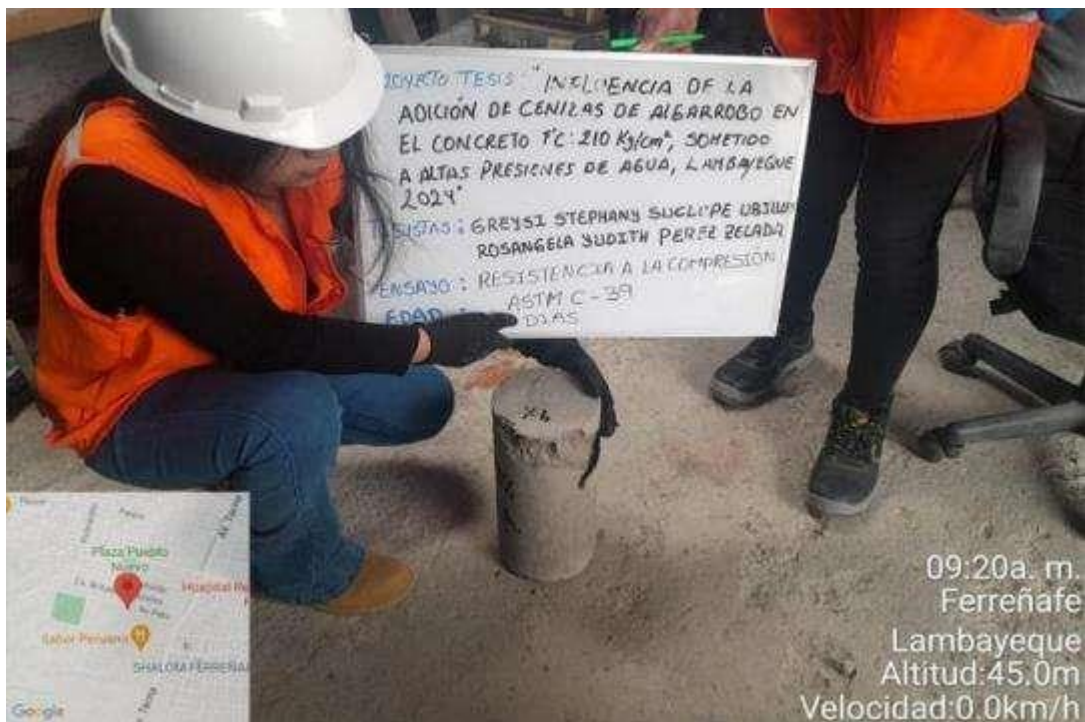
Fotografía N° 33: tipo de rotura 5 en el ensayo de compresión, edad 7 días con adición de 9% de ceniza de algarrobo.
