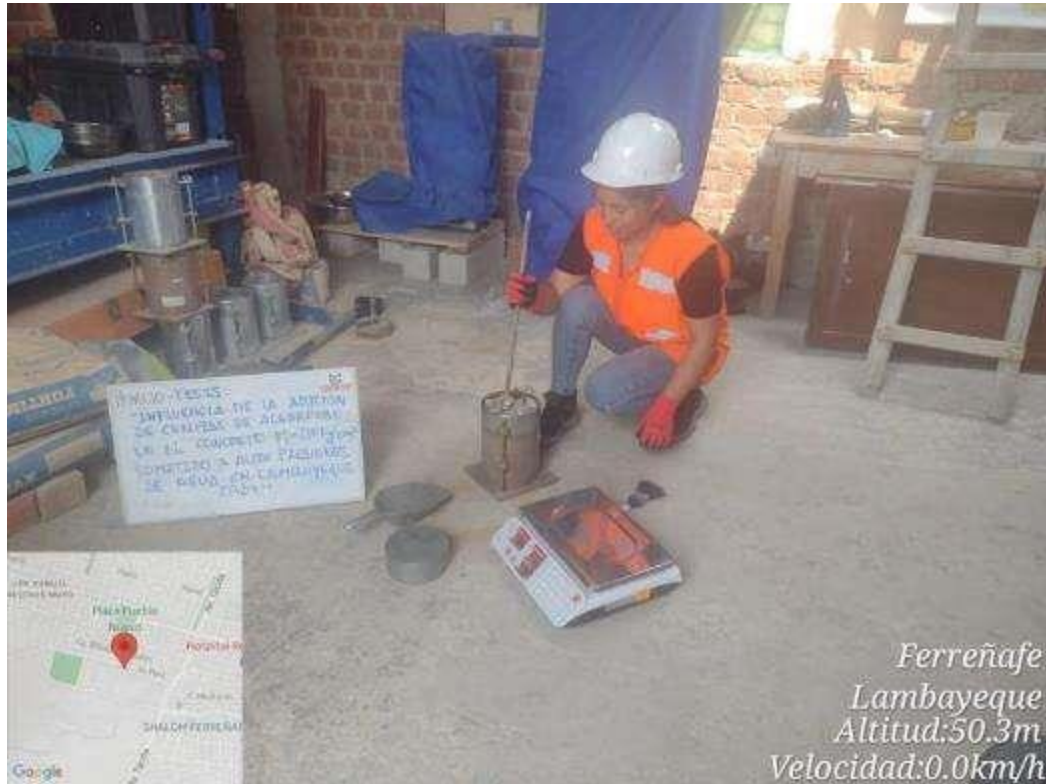
Fotografía N° 26: Mezclado de los materiales adicionando la ceniza de algarrobo para el diseño de concreto
