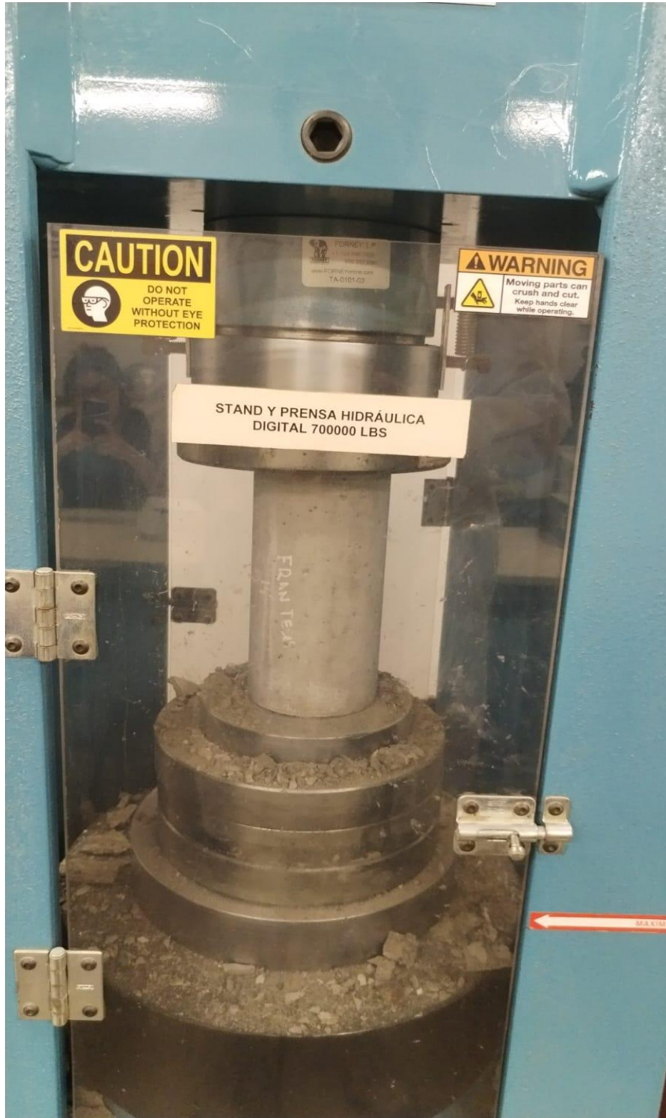
Figure 41. Demostración de rotura 28 días compresión
