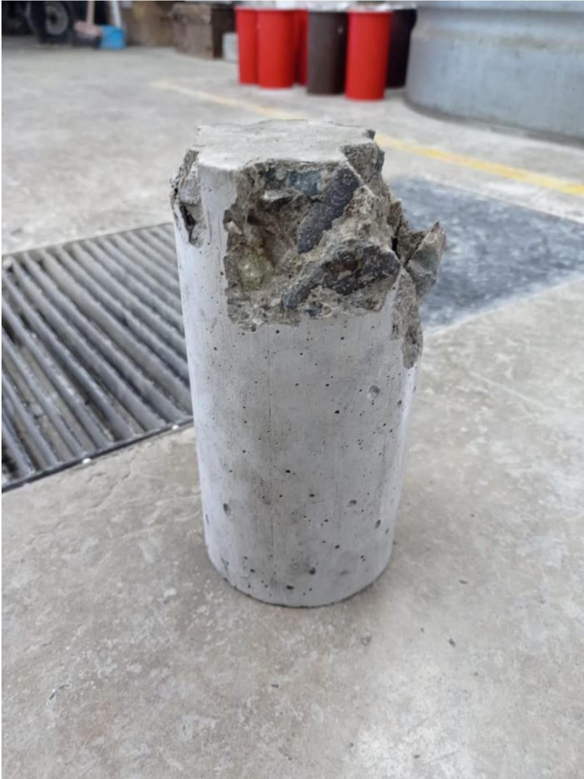
Figure 39. Probeta bioconcreto 28 días compresión
