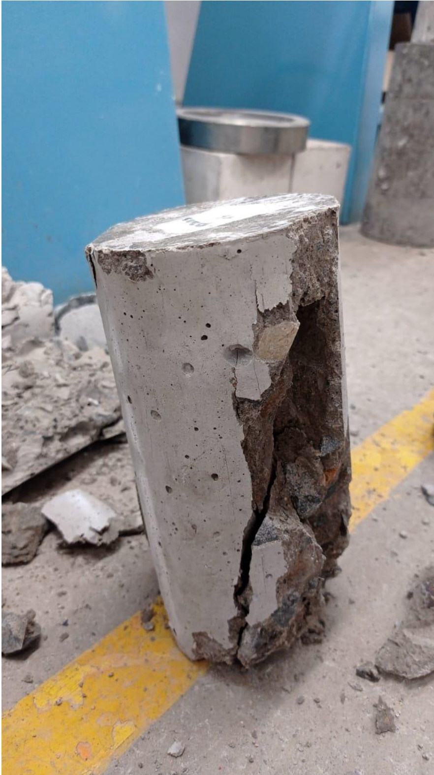
Figure 40. Demostración de probeta patrón 28 días compresión
