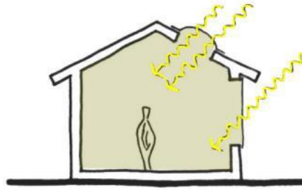
Figura 17: Esquema de captación térmica
