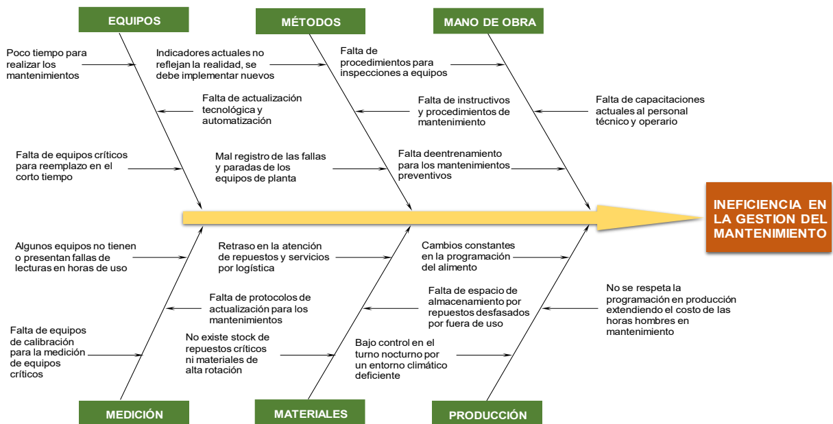
Figura 3: Diagrama de causa efecto sobre la gestión del mantenimiento en la planta molino.
