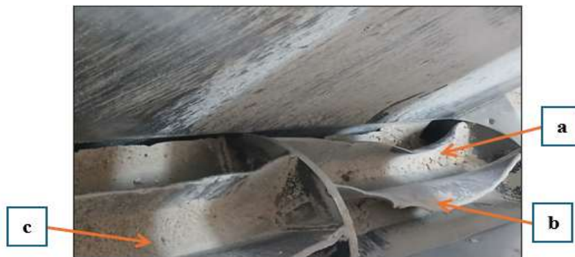
Figura 1: Atoro en válvula alimentadora de maíz por ingreso de material extraño.
