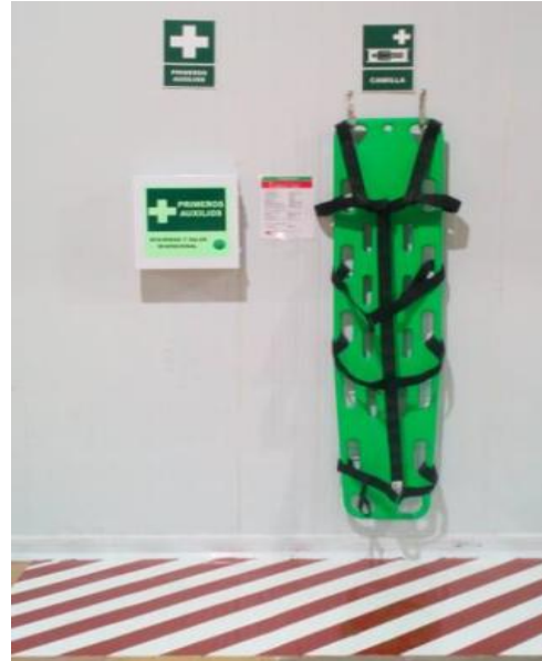
Figura 1. Zona de camilla de emergencia delimitado el piso y con la señalización correcta
