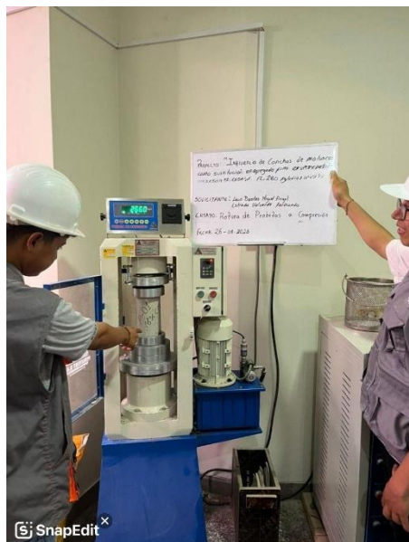
Ensayo de resistencia a la compresión
