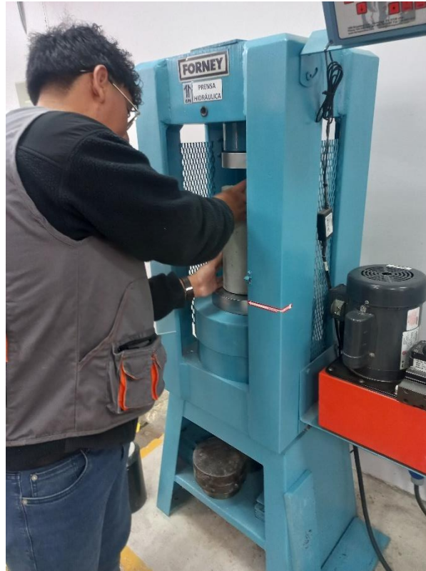
Imagen 07: Rotura De Probetas
