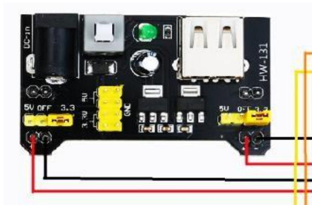
Fig. 13 HW-131 Fuente de alimentación
