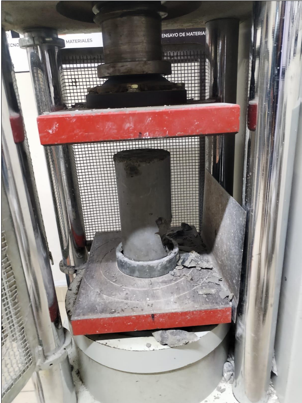
Ensayo de la resistencia a la compresión
