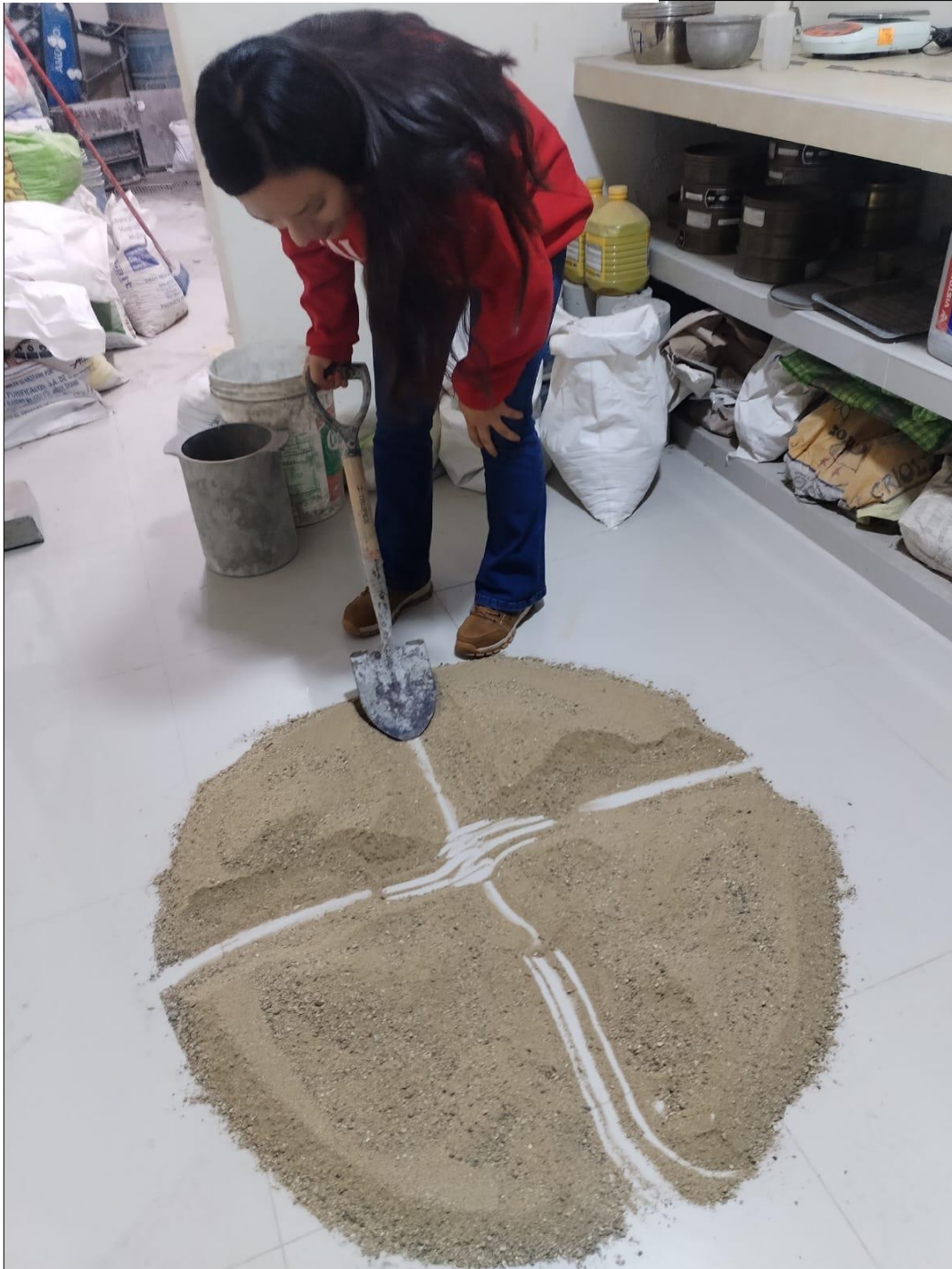
Figura 41 Caracterización de agregado fino – cuarteo de muestra
