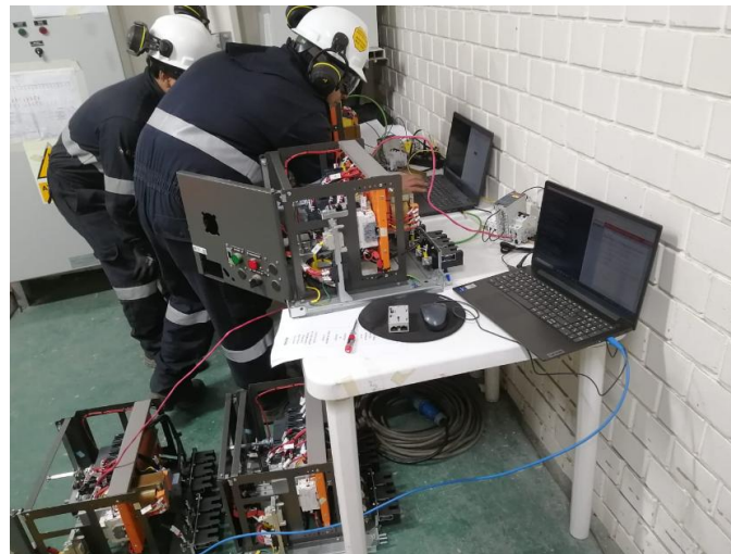
Figura 40. Pruebas de arranque directo E300
