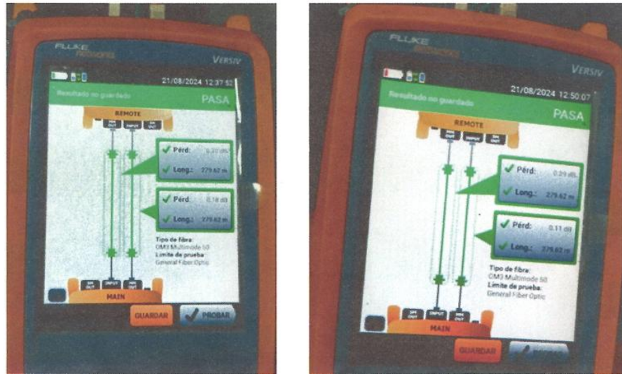
Figura 47. Medición de calidad de fibra óptica
