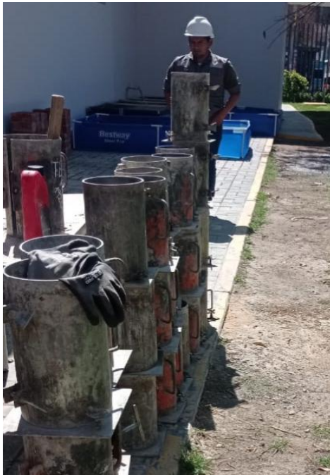
Fotografía N° 11: Desmolde y colocación de especímenes en la poza de curado.
