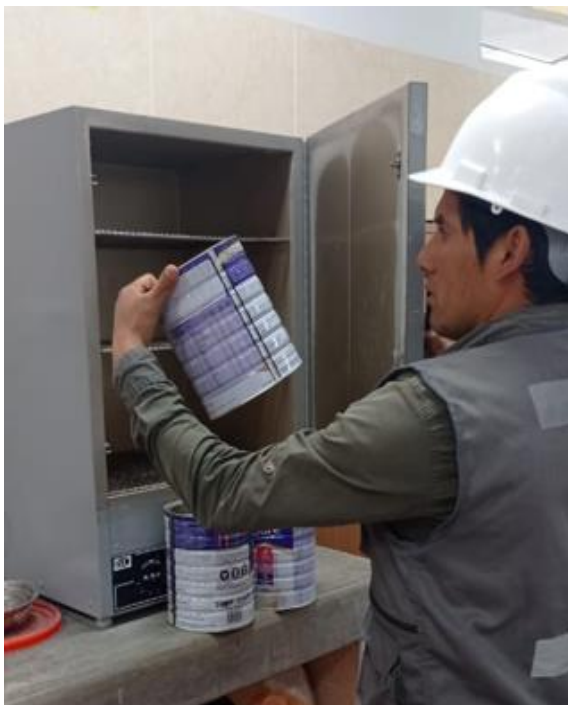
Fotografía N° 3: Horno a temperatura constante de 110\text{ }^{\circ}\text{C} \pm 5\text{ }^{\circ}\text{C} .
