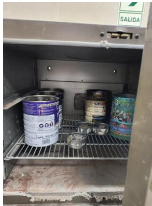
Fotografía N° 3: Horno a temperatura constante de 110\text{ }^{\circ}\text{C} \pm 5\text{ }^{\circ}\text{C} .
