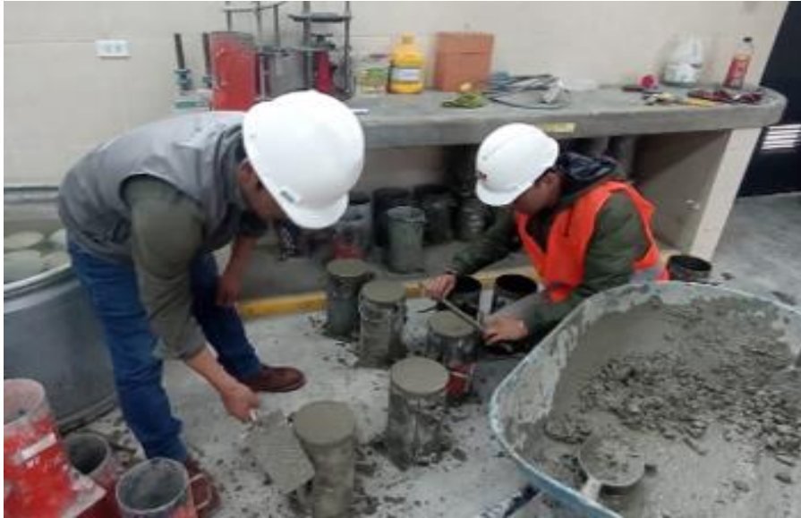
Fotografía N° 10: Elaboración de especímenes de acuerdo al método ACI 211.1
