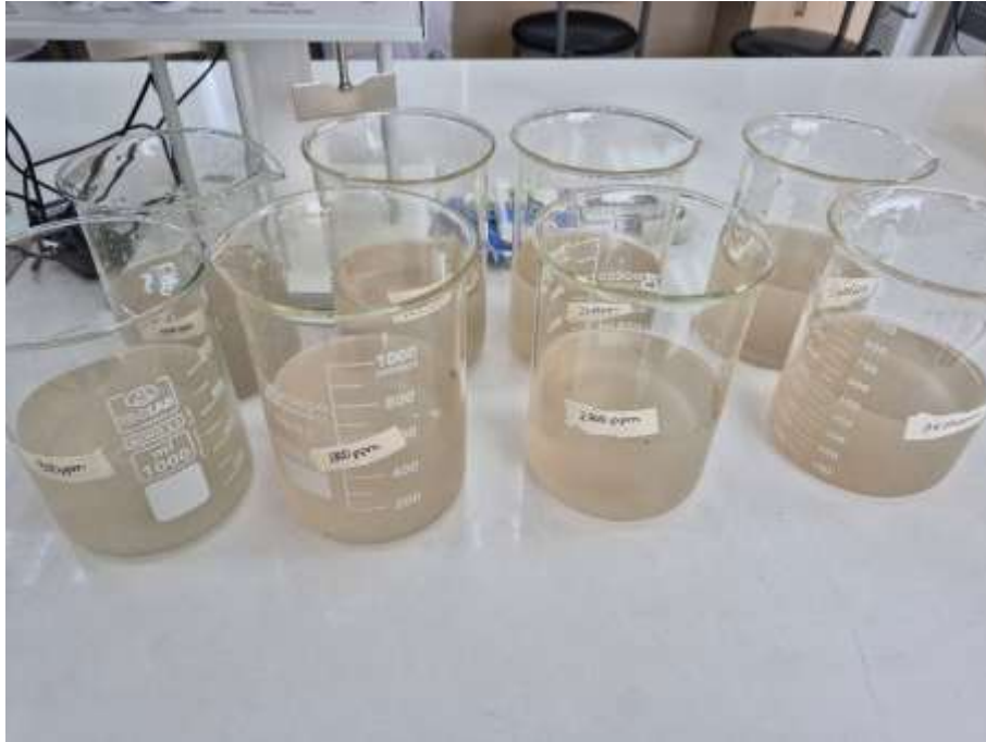
Antes de la Prueba de jarras con coagulante Cicer arietinum a un pH de 7.86 y sus duplicados
