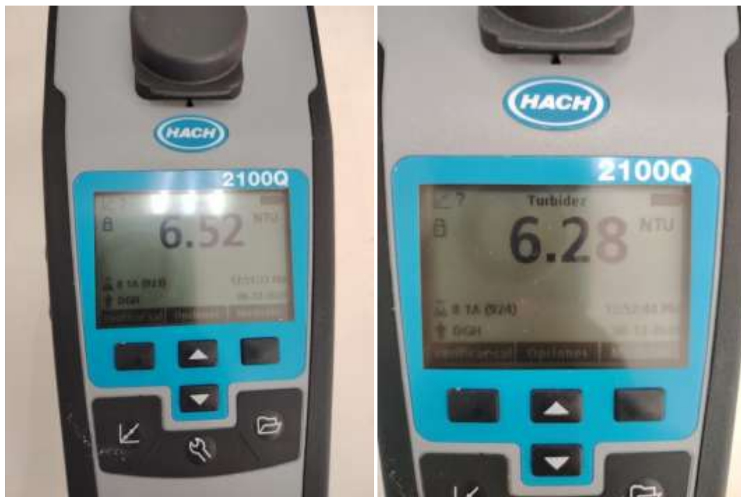
Resultados de turbidez en T2 (dosis: 900 mg/L, pH: 7.86)
