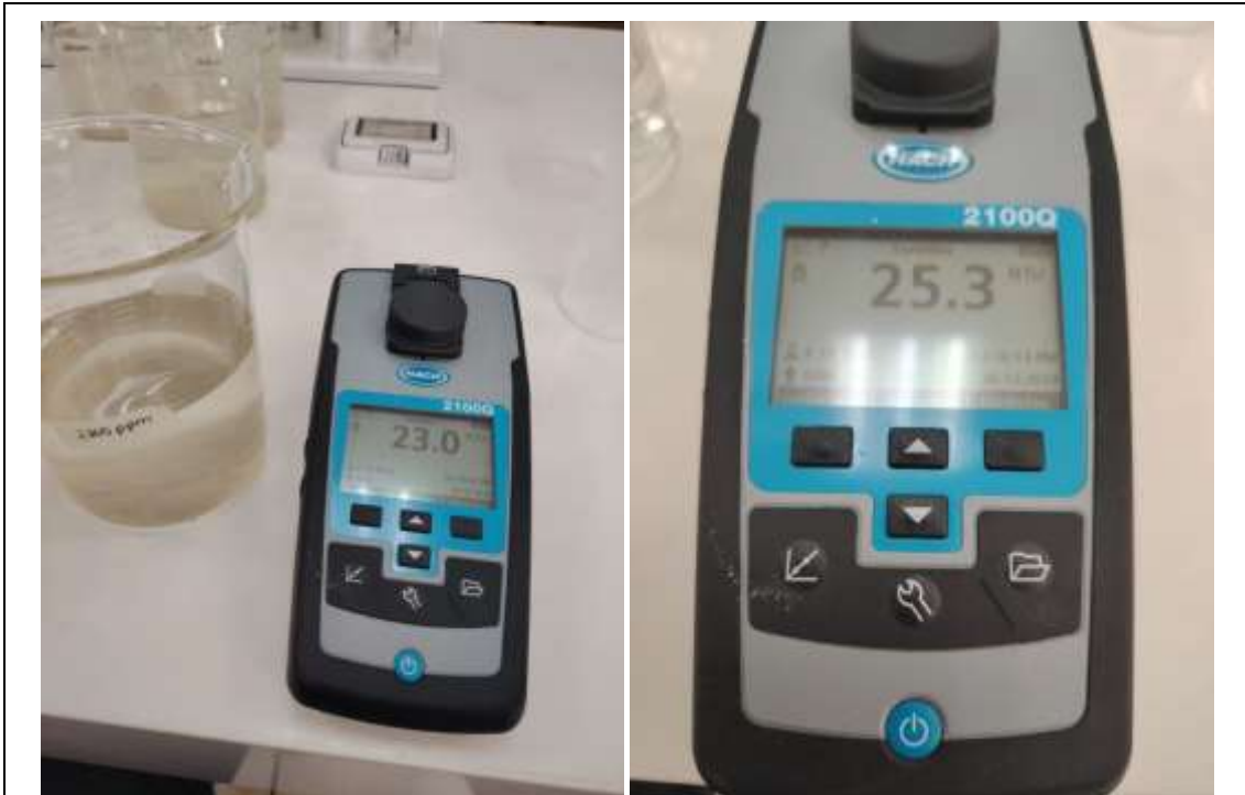
Resultados de turbidez en T5 (dosis: 2700 mg/L, pH: 5.75)
