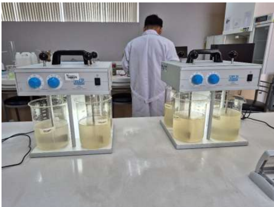
Durante la Prueba de jarras con coagulante Cicer arietinum a un pH de 7.86 y sus duplicados
