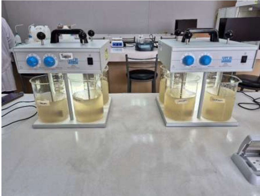
Durante la Prueba de jarras con coagulante Cicer arietinum a un pH de 5.75 y sus duplicados
