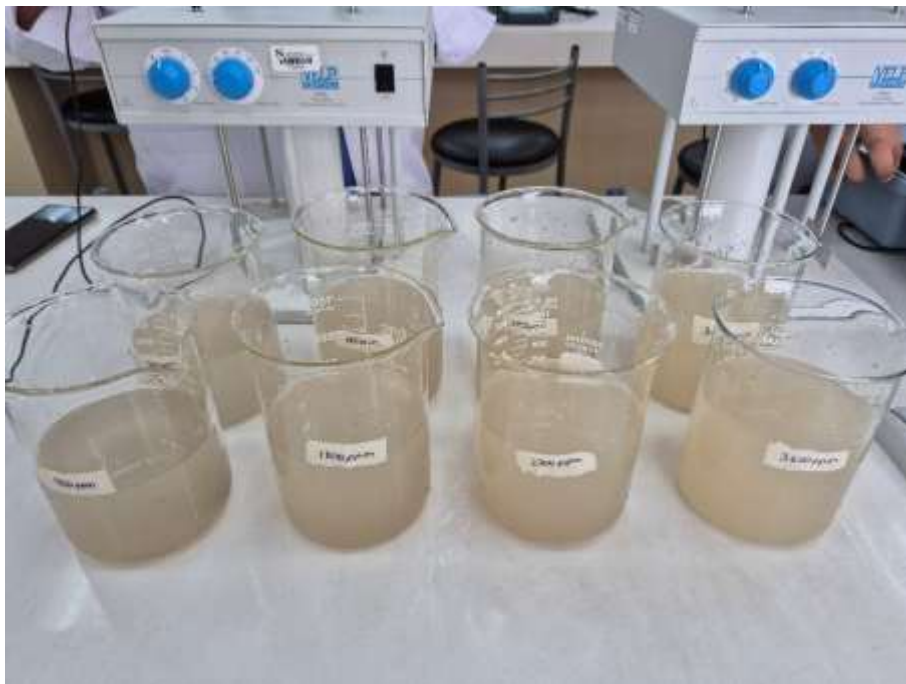
Antes de la Prueba de jarras con coagulante Cicer arietinum a un pH de 5.75 y sus duplicados
