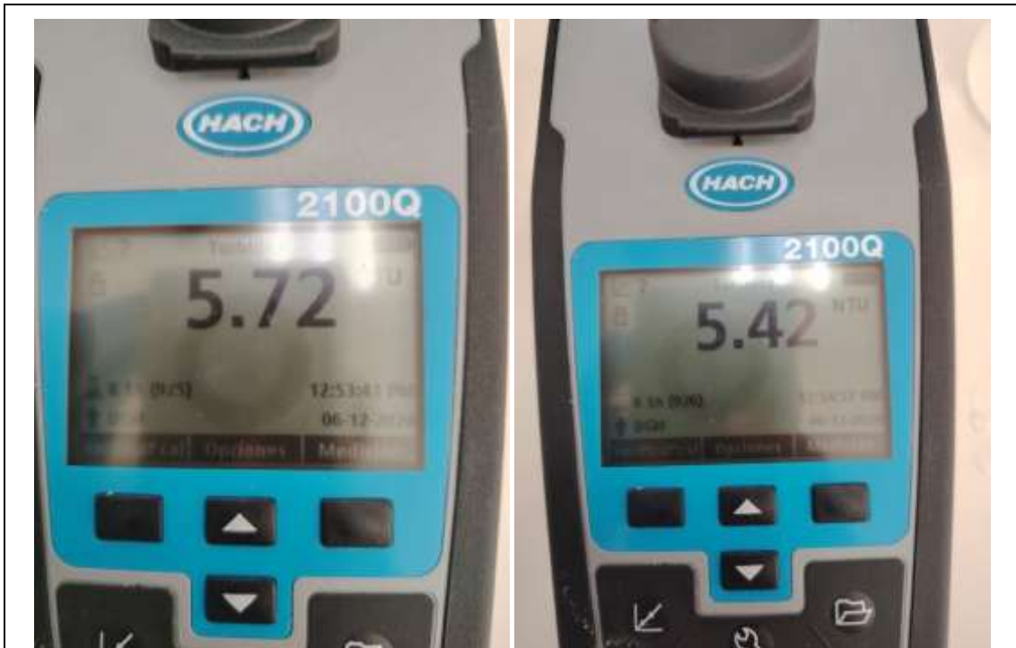
Resultados de turbidez en T4 (dosis: 1800 mg/L, pH: 7.86)
