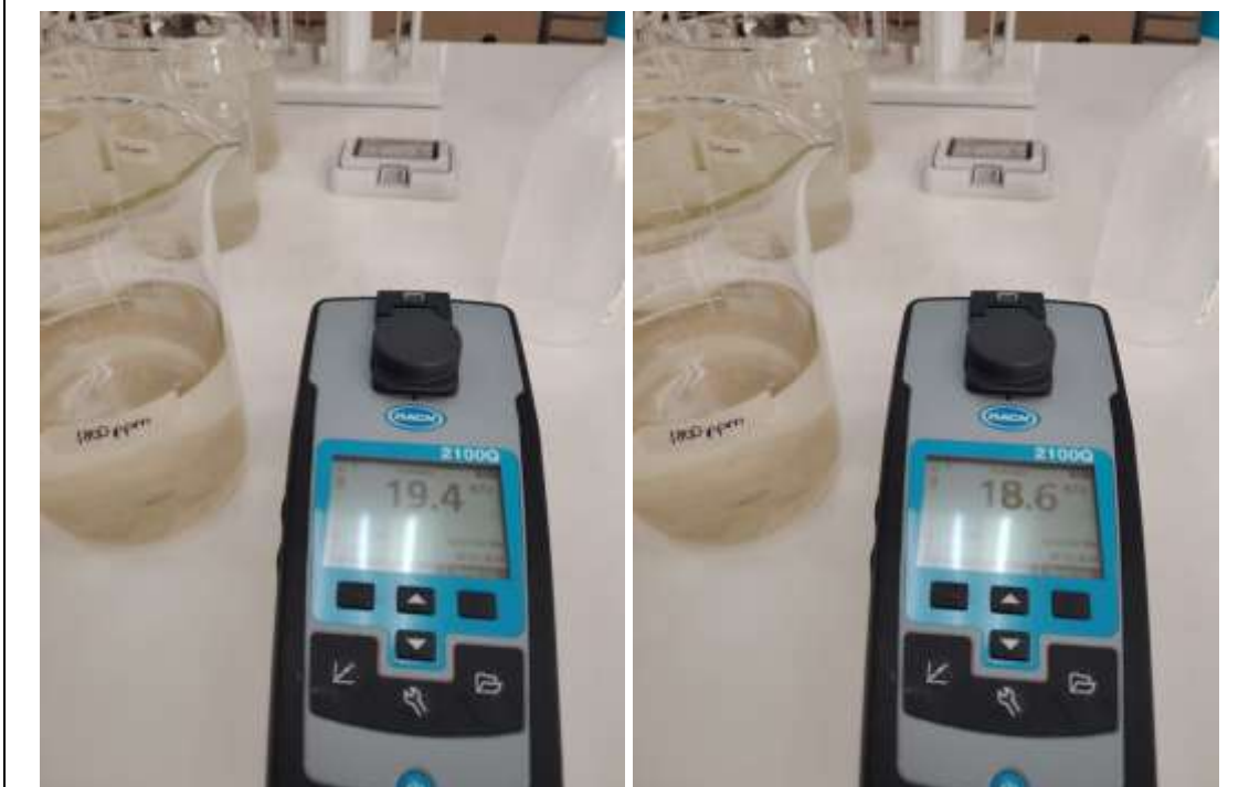
Resultados de turbidez en T3 (dosis: 1800 mg/L, pH: 5.75)
