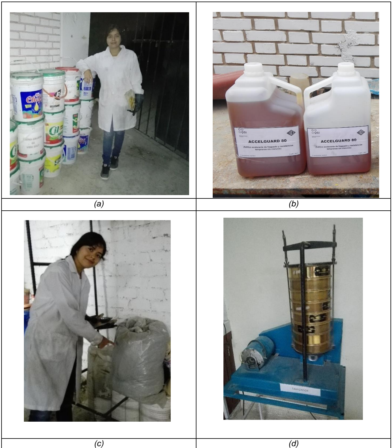
Figura N.º 30: (a) Envasado del agregado fino; (b) Aditivo accelguard 80; (c) Microsilíce Sika fume; (d) Tamizador, laboratorio UNT.
