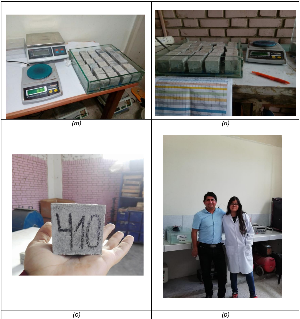
Figura N.º 33: (m) Ensayo de capilaridad; (n) Ensayo de capilaridad con hoja de control; (o) Ultima probeta desmoldada; (p) Autora de tesis con Ing. asesor, laboratorio UNT.
