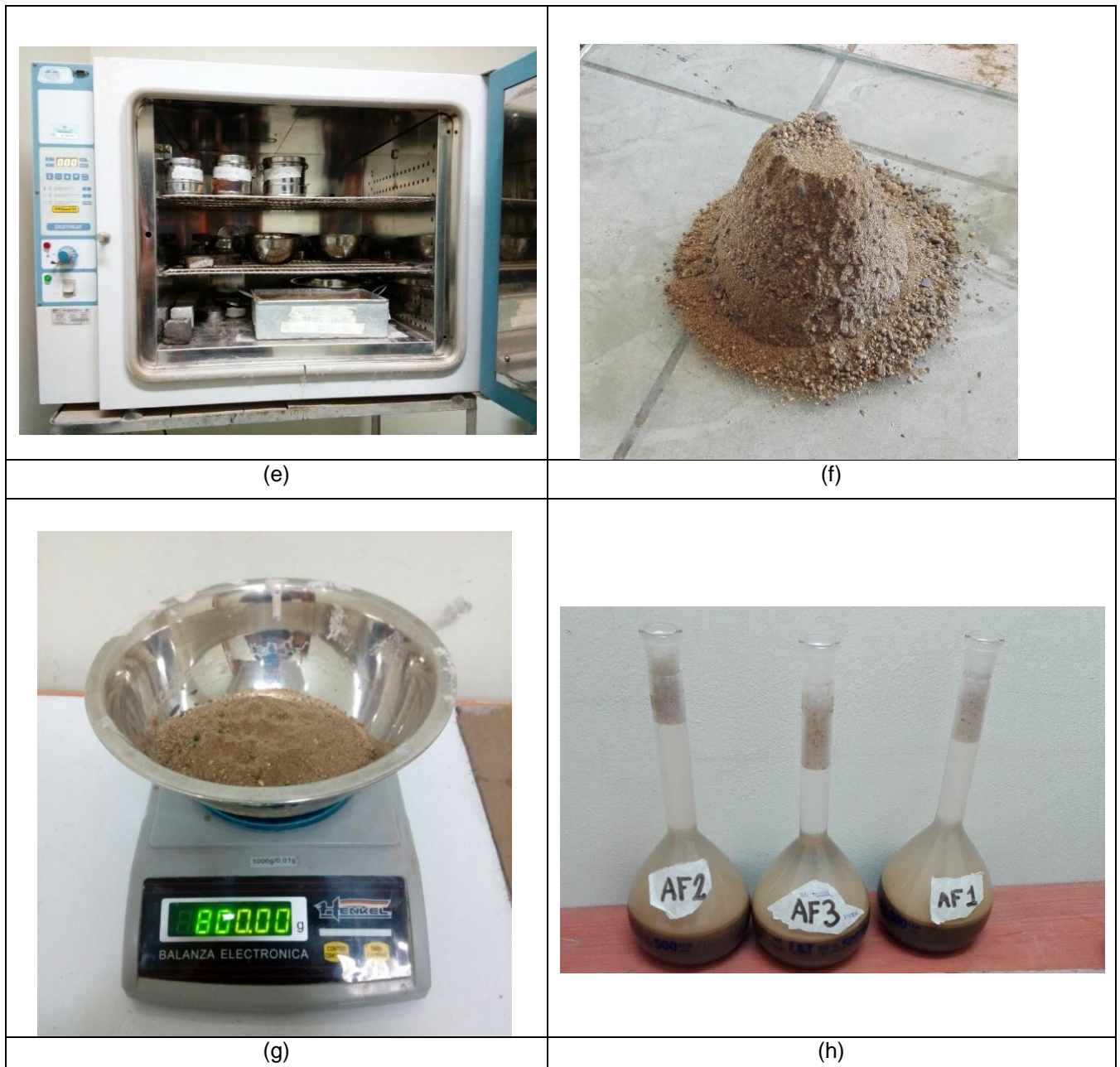
Figura N.º 31: (e) Ensayo de humedad, estufa; (f) Ensayo de peso específico; (g) Pesaje de muestra en balanza electrónica; (h) Muestras en fiola con agua, laboratorio UNT.
