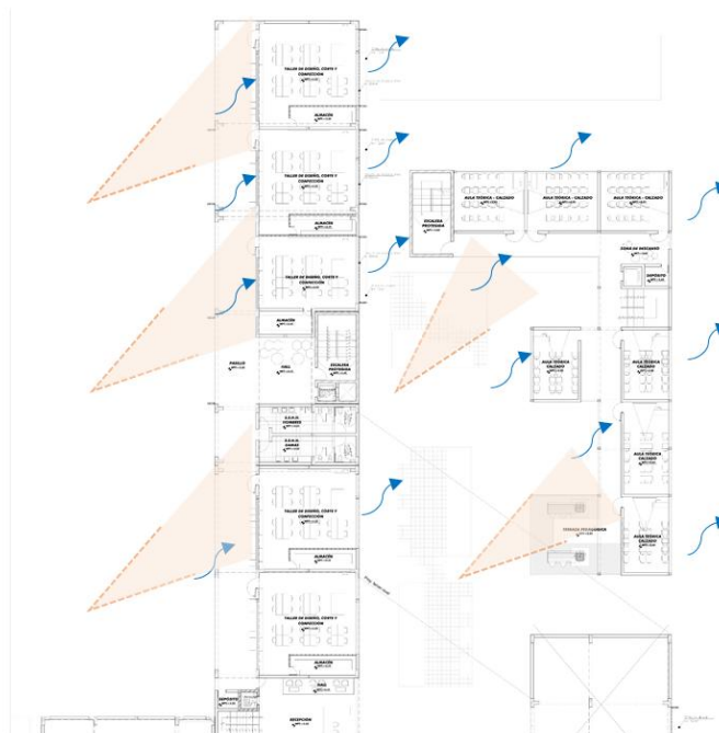
Figura 104 Ventilación cruzada e iluminación natural - Segundo nivel
