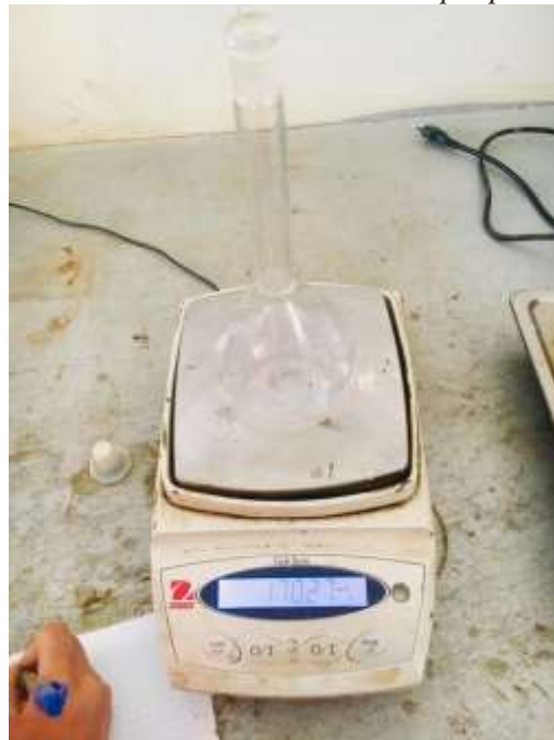
Fotografía 22: Ensayo Peso Específico y Absorción del Agregado Fino, peso de la fiola 170.27 gramos.
