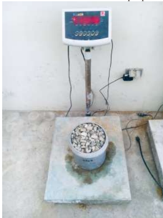
Fotografía 14: Ensayo Peso Unitario Suelto del Agregado Grueso, peso del Recipiente más Agregado grueso 14.290 kilogramos. Base de datos - Elaboración propia
