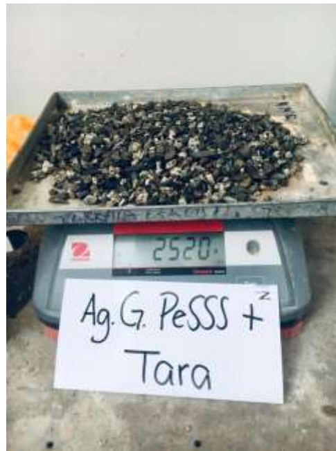
Fotografía 31: Ensayo Peso Específico del Agregado Grueso, peso de material en estado SSS más tara 2520 gramos. Base de datos - Elaboración propia
