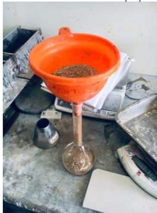
Fotografía 24: Ensayo Peso Específico y Absorción del Agregado Fino, colocación del Agregado fino en la fiola. Base de datos - Elaboración propia
