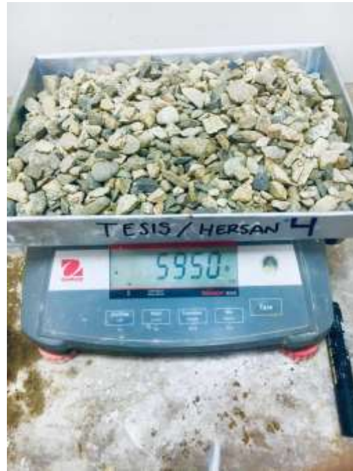
Fotografía 3: Ensayo Análisis Granulométrico de Agregado Grueso, peso de la muestra 5500 gramos más tara de 450 gramos. Base de datos - Elaboración propia
