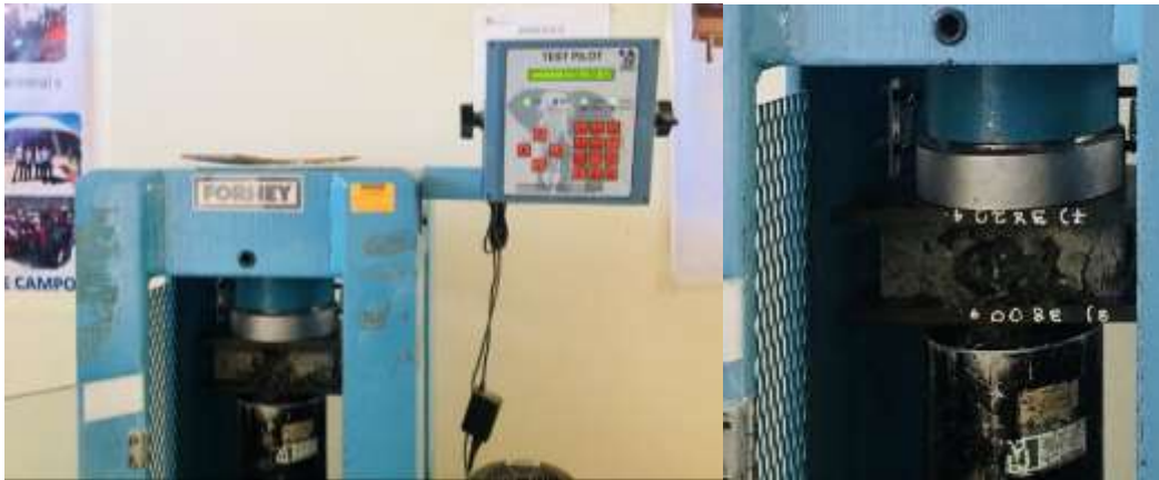
Fotografía 39: Proceso de Rotura de probetas para el ensayo de resistencia a la compresión de los adoquines - BETA 5% Base de datos - Elaboración propia
