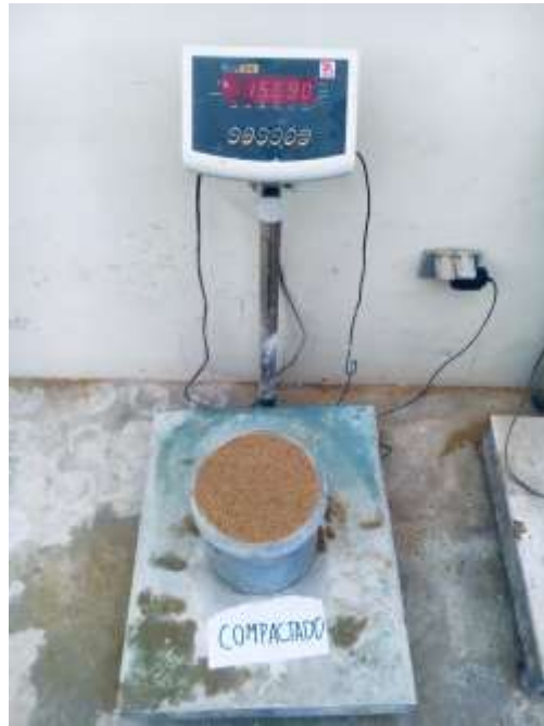
Fotografía 11: Ensayo Peso Unitario Compactado del Agregado Fino, peso del Recipiente más Agregado fino 15.690 kilogramos. Base de datos - Elaboración propia
