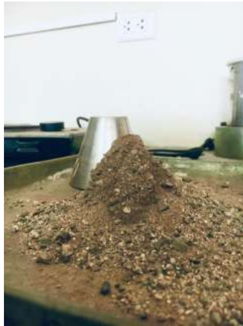
Fotografía 21: Ensayo Peso Específico y Absorción del Agregado Fino, comparación del material y el molde cónico con el fin de demostrar la obtención del estado SSS del Agregado fino.
