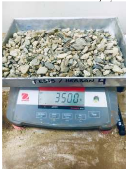
Fotografía 6: Ensayo Contenido de Humedad de Agregado Grueso, peso de la muestra 3500 gramos. Base de datos - Elaboración propia
