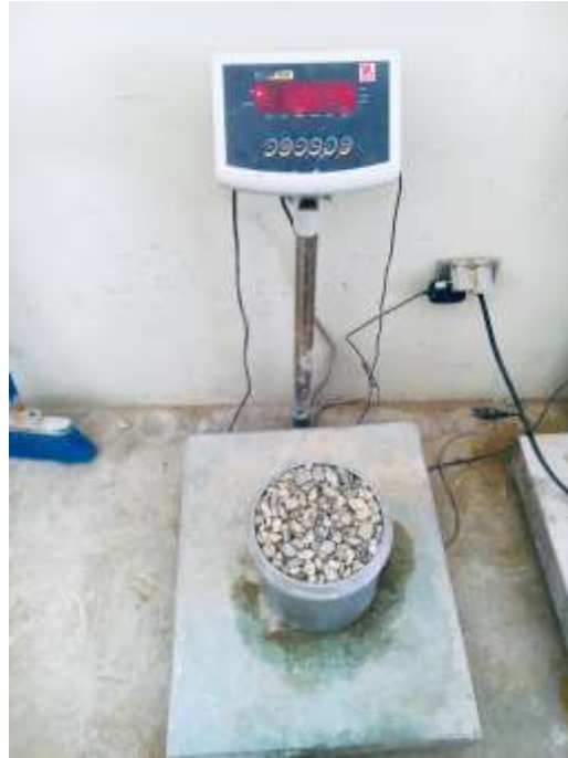
Fotografía 17: Ensayo Peso Unitario Compactado del Agregado Grueso, peso del Recipiente más Agregado grueso 15.275 kilogramos. Base de datos - Elaboración propia
