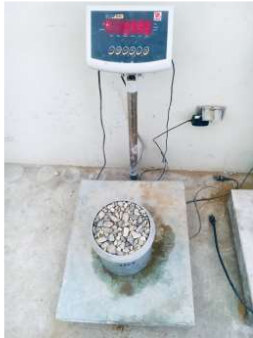
Fotografía 15: Ensayo Peso Unitario Suelto del Agregado Grueso, peso del Recipiente más Agregado grueso 14.395 kilogramos.
