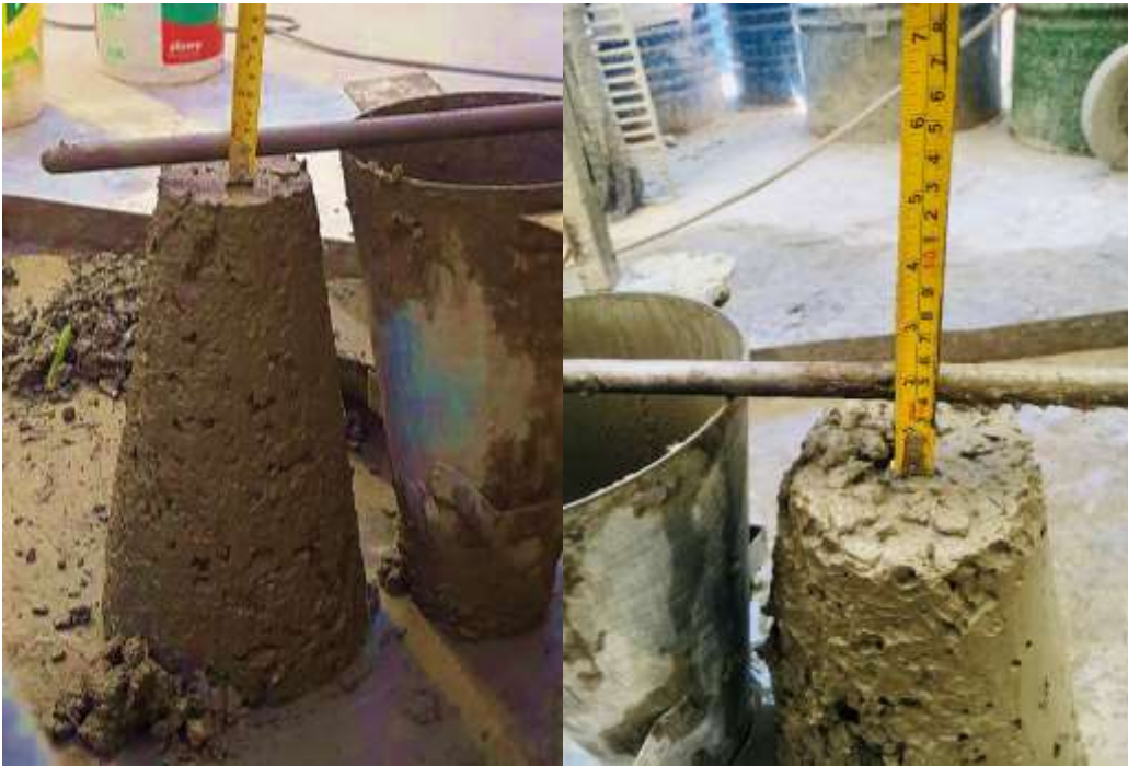
Fotografía 35: Evaluación del ensayo de SLUMP o Asentamiento del estado fresco de la mezcla, comparación de la tanda #2 ALFA con la tanda #1 de BETA 15%. Base de datos - Elaboración propia
