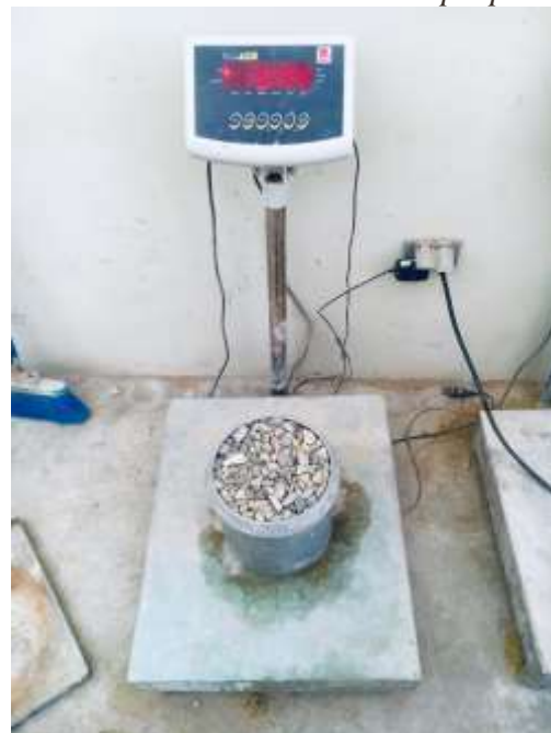
Fotografía 16: Ensayo Peso Unitario Compactado del Agregado Grueso, peso del Recipiente más Agregado grueso 15.285 kilogramos.
