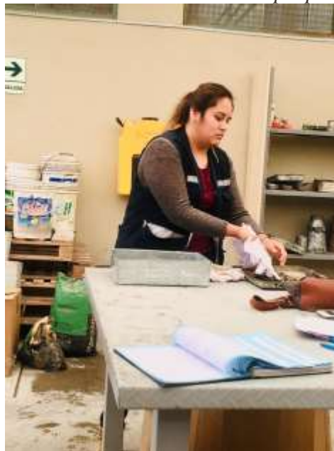
Fotografía 29: Ensayo Peso Específico del Agregado Grueso, peso del material; 2000 gramos, a ser colocado al horno por 24 +/-4 horas. Base de datos - Elaboración propia
