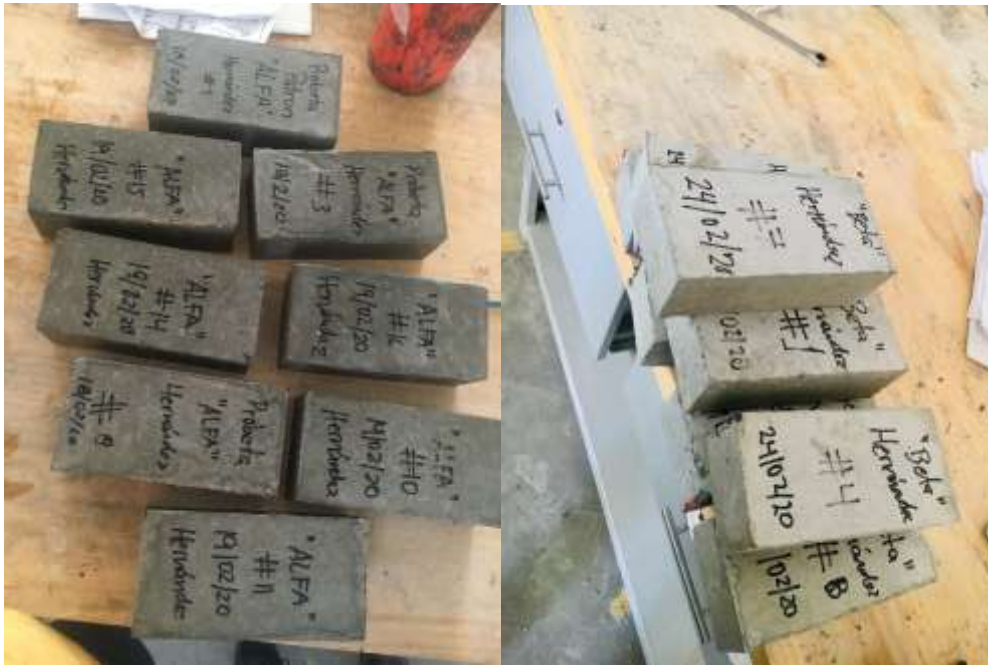
Fotografía 37: desencofrado de las probetas y codificación de estas. Base de datos - Elaboración propia
