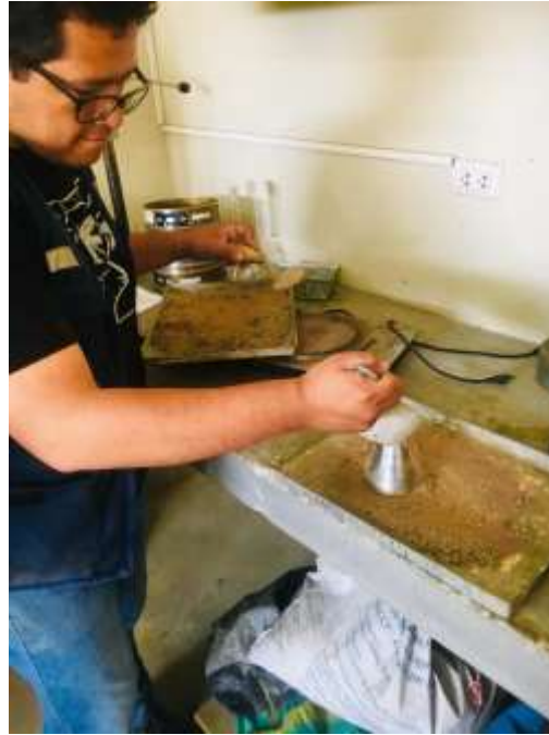
Fotografía 19: Ensayo Peso Específico y Absorción del Agregado Fino, colocación del material en el molde cónico con el fin de obtener el estado SSS del Agregado fino. Base de datos - Elaboración propia
