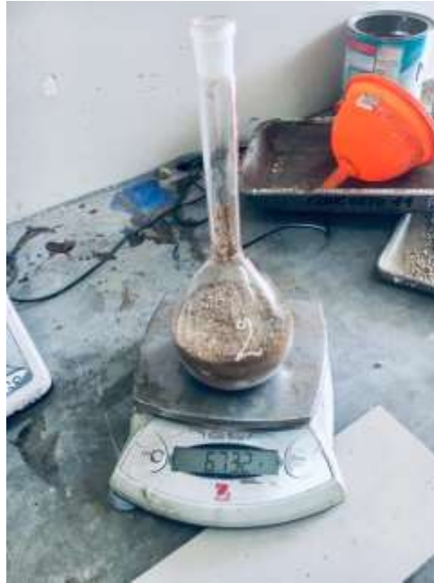
Fotografía 25: Ensayo Peso Específico y Absorción del Agregado Fino, peso del material y de la fiola 673.2 gramos. Base de datos - Elaboración propia
