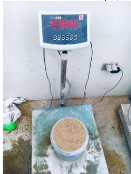
Fotografía 8: Ensayo Peso Unitario Suelto del Agregado Fino, peso del Recipiente más Agregado fino 14.345 kilogramos. Base de datos - Elaboración propia
