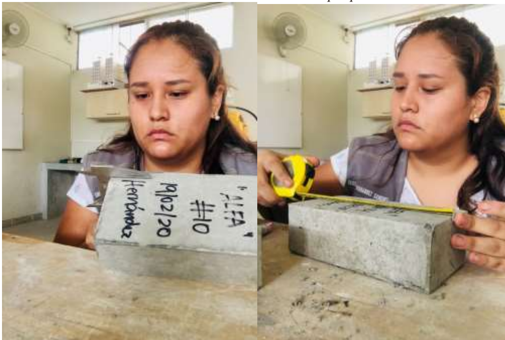
Fotografía 38: Evaluación del dimensionamiento y variación estándar de los adoquines. Base de datos - Elaboración propia
