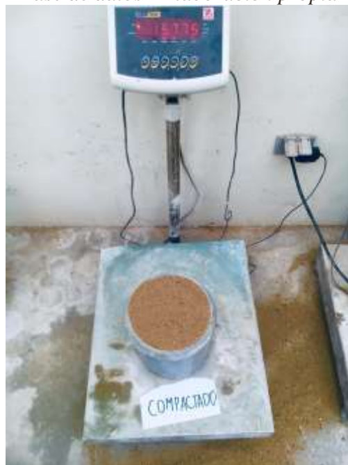
Fotografía 12: Ensayo Peso Unitario Compactado del Agregado Fino, peso del Recipiente más Agregado fino 15.775 kilogramos. Base de datos - Elaboración propia
