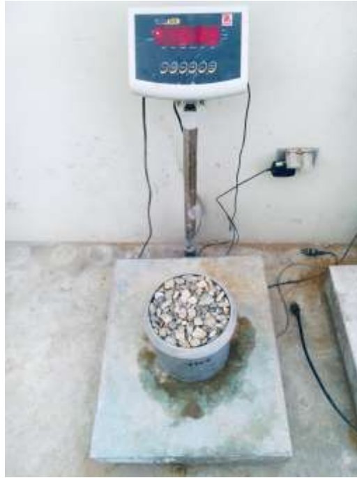
Fotografía 13: Ensayo Peso Unitario Suelto del Agregado Grueso, peso del Recipiente más Agregado grueso 14.160 kilogramos. Base de datos - Elaboración propia
