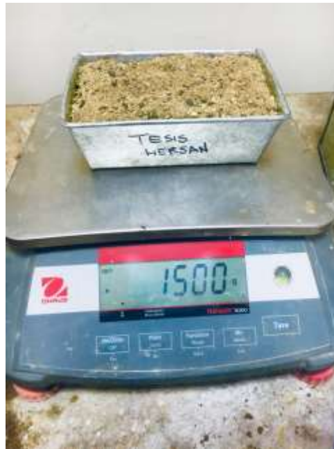
Fotografía 1: Ensayo Análisis Granulométrico de Agregado Fino, peso de la muestra 1500 gramos.
