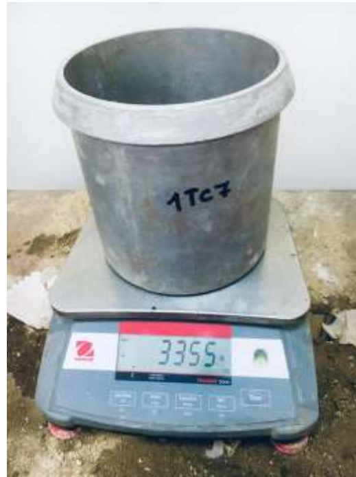
Fotografía 7: Ensayo Peso Unitario Suelto y Compactado del Agregado Fino y Grueso, peso del Recipiente 3.355kilogramos. Base de datos - Elaboración propia
