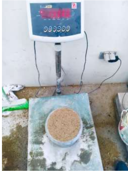
Fotografía 9: Ensayo Peso Unitario Suelto del Agregado Fino, peso del Recipiente más Agregado fino 14.380 kilogramos. Base de datos - Elaboración propia
