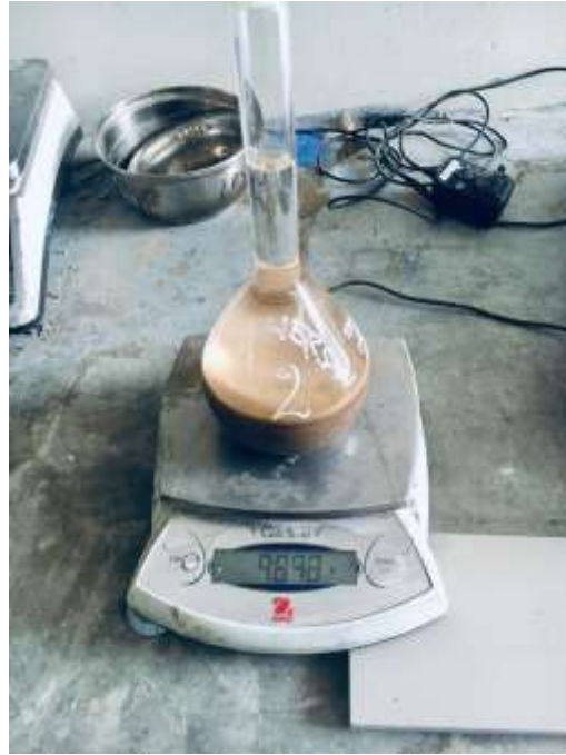
Fotografía 27: Ensayo Peso Específico y Absorción del Agregado Fino, peso de la fiola más agregado fino y agua hasta la marca de calibración 989.8 gramos. Base de datos - Elaboración propia
