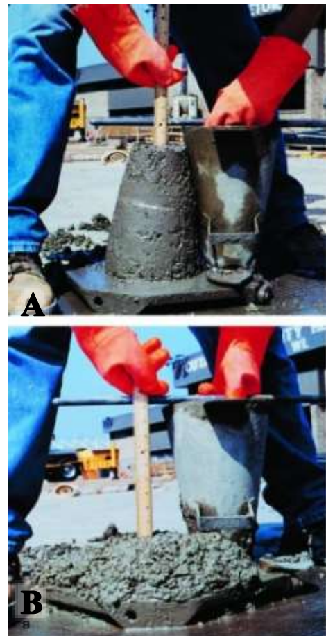
Figure 18: Ensayo de SLUMP (asentamiento de cono de Abrams). Figura A: asentamiento bajo. Figura B: asentamiento mayor
