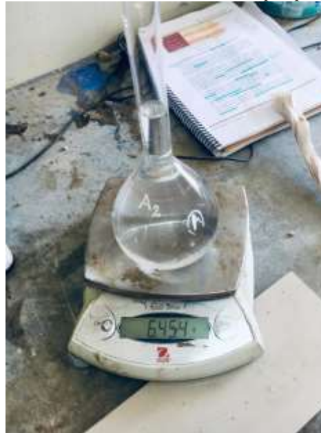
Fotografía 25: Ensayo Peso Específico y Absorción del Agregado Fino, peso del material y de la fiola 673.2 gramos. Base de datos - Elaboración propia
