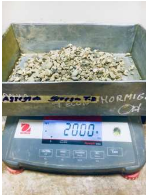
Fotografía 29: Ensayo Peso Específico del Agregado Grueso, peso del material; 2000 gramos, a ser colocado al horno por 24 +/-4 horas. Base de datos - Elaboración propia
