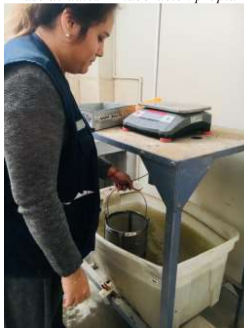
Fotografía 32: Ensayo Peso Específico del Agregado Grueso, colocación del material SSS en el agua.. Base de datos - Elaboración propia
