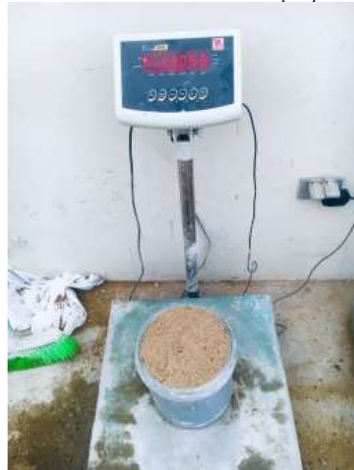
Fotografía 10: Ensayo Peso Unitario Suelto del Agregado Fino, peso del Agregado fino 11.055 kilogramos. Base de datos - Elaboración propia
