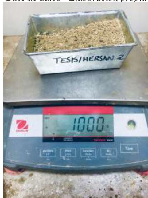
Fotografía 2: Ensayo de Contenido de Humedad, peso de la muestra 1000 gramos.
