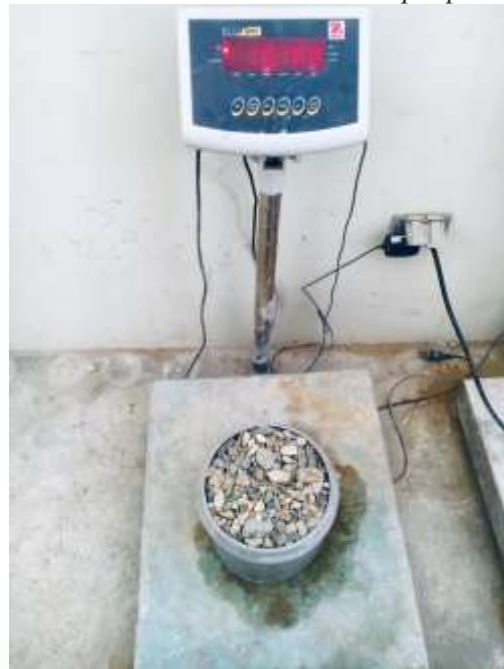
Fotografía 18: Ensayo Peso Unitario Compactado del Agregado Grueso, peso del Recipiente más Agregado grueso 15.155 kilogramos. Base de datos - Elaboración propia
