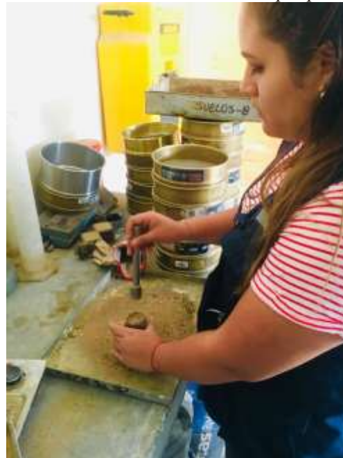
Fotografía 19: Ensayo Peso Específico y Absorción del Agregado Fino, colocación del material en el molde cónico con el fin de obtener el estado SSS del Agregado fino. Base de datos - Elaboración propia
