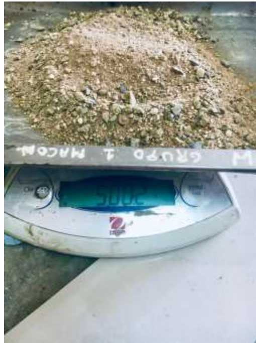
Fotografía 23: Ensayo Peso Específico y Absorción del Agregado Fino, peso del Agregado fino 500.2 gramos. Base de datos - Elaboración propia
