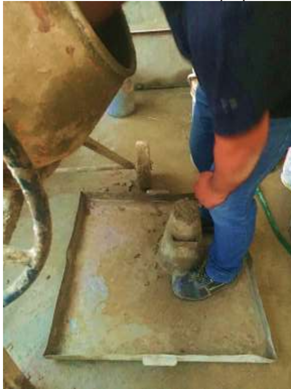
Fotografía 34: Elaboración de ensayo de SLUMP o Asentamiento del estado fresco de la mezcla Base de datos - Elaboración propia
