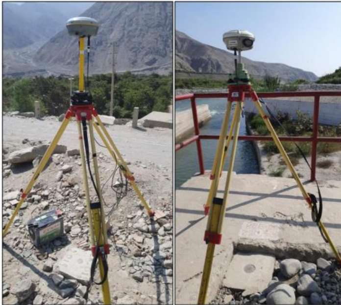
Figura 19. Equipo de Medición de Línea Base.
