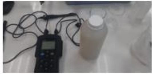
Figura 7. Evaluación de los parámetros fisicoquímicos de las muestras de agua (pH y conductividad) en el laboratorio
