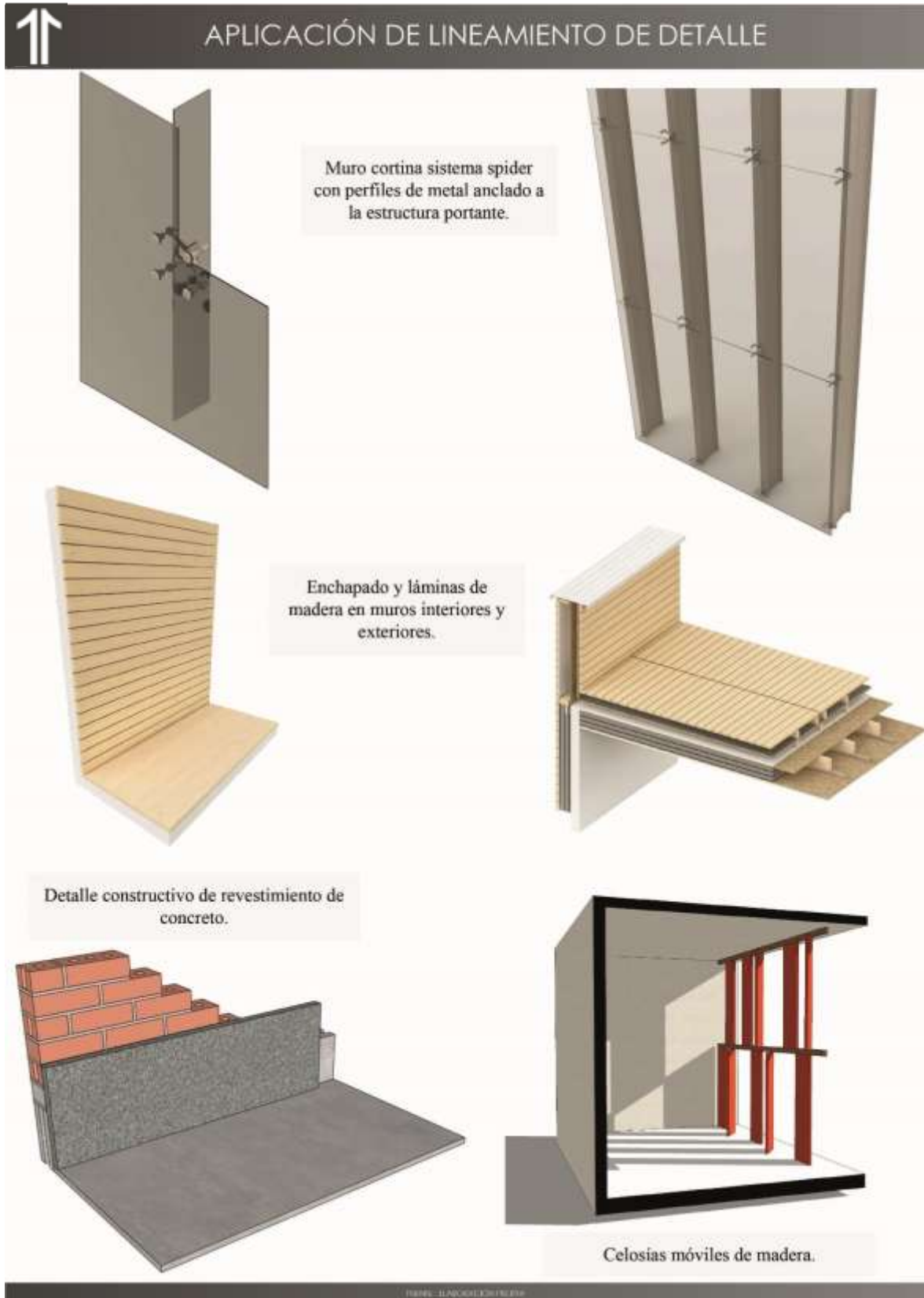
Figura 68: Gráfico de lineamientos de detalle y materiales
