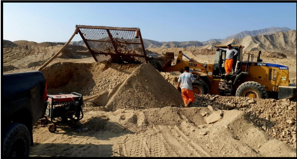
Figura 44. Zarandeo del Material en cantera, para su utilización en campo.
