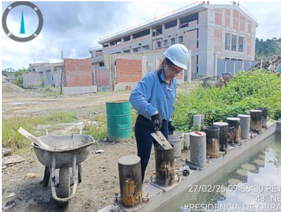
Figura 7 Moldeo de probetas para ensayo de compresión
