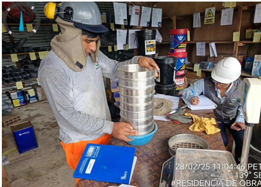
Figura 5 Ensayo de Granulometría In Situ
