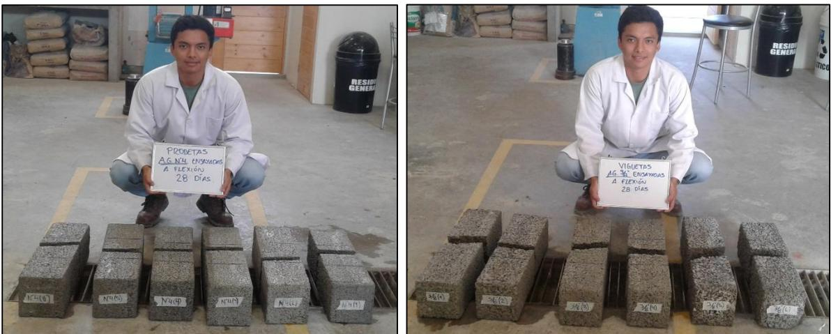
**Figura 45:** Viguetas con gradación N° 4 y 3/8" ensayadas a Flexión. Fuente: Autor de Tesis.
