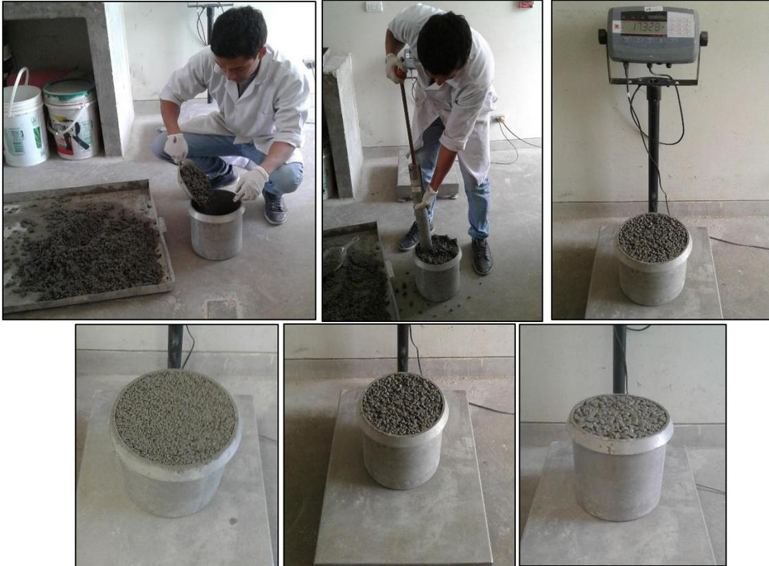
**Figura 49:** Ensayo de Densidad y Contenido de Vacíos en estado fresco. **Fuente:** Autor de Tesis.
