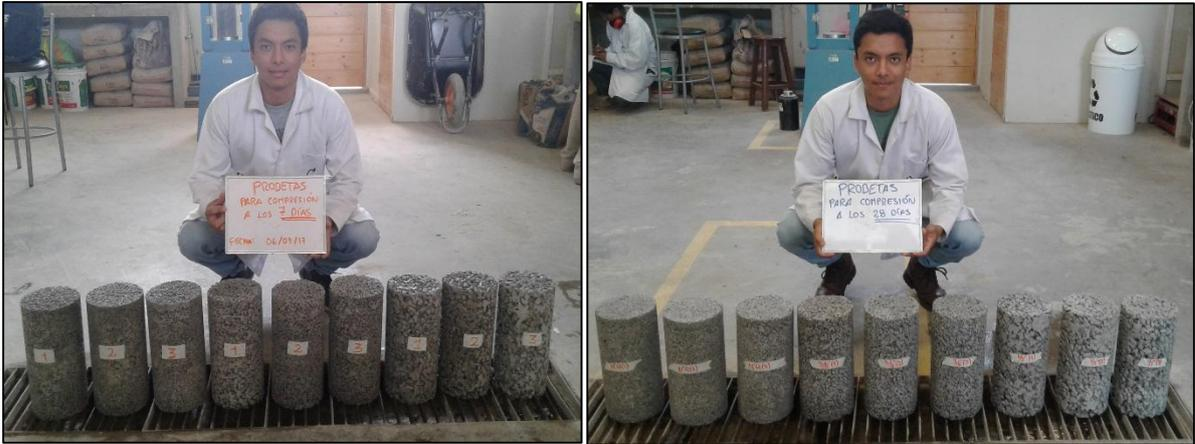
**Figura 43:** Probetas para ensayo a la Compresión a 7 y 28 días. Fuente: Autor de Tesis.
