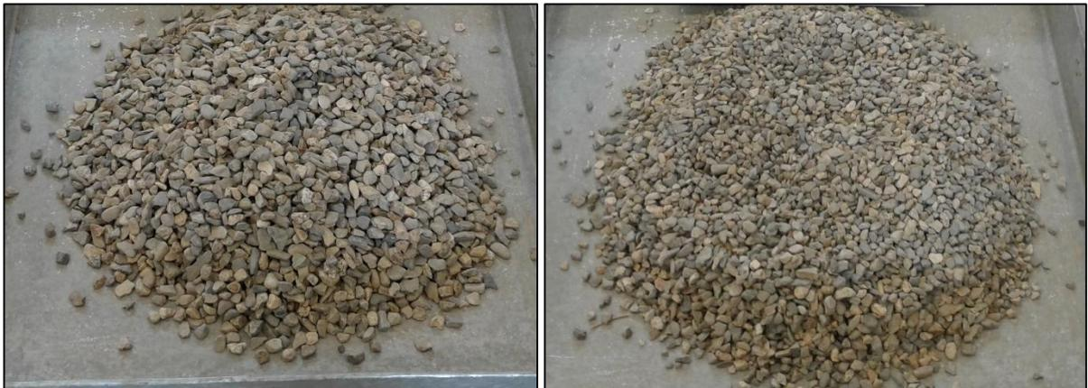
**Figura 33:** Gradaciones de 1/2" y 3/8". **Fuente:** Autor de Tesis.
