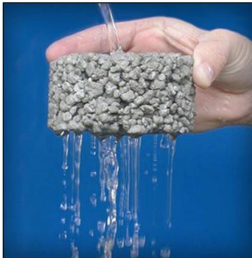
**Figura 1:** Muestra de Concreto permeable.
