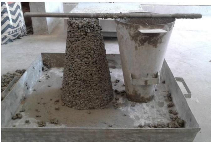
**Figura 2:** Cono de Abrams (Asentamiento del concreto permeable).
