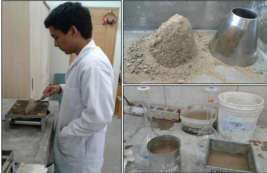
**Figura 38:** Peso Específico y Absorción del agregado fino. **Fuente:** Autor de Tesis.
