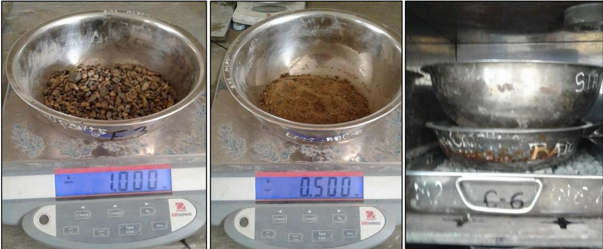
**Figura 35:** Contenido de Humedad del agregado grueso y fino. **Fuente:** Autor de Tesis.
