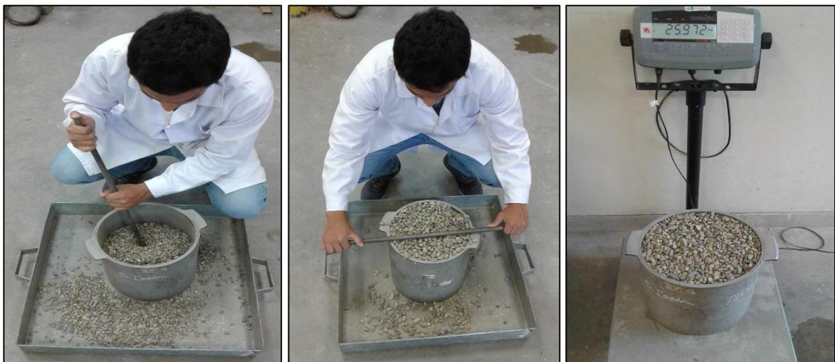
**Figura 36:** Peso Unitario Suelto y Compactado de los agregados. **Fuente:** Autor de Tesis.
