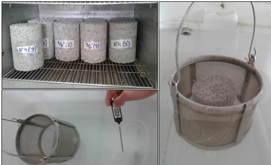
**Figura 50:** Ensayo de Densidad y Contenido de Vacíos en estado endurecido. **Fuente:** Autor de Tesis
