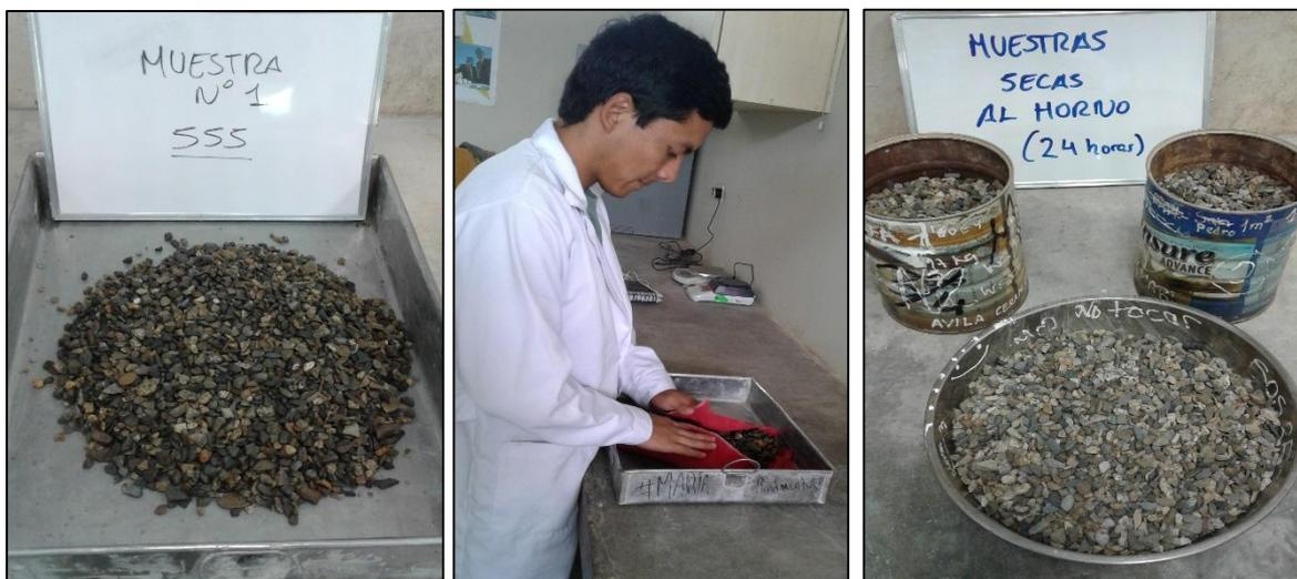
**Figura 37:** Peso Específico y Absorción del agregado grueso. **Fuente:** Autor de Tesis.
