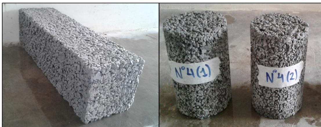
**Figura 7:** Probetas para la prueba de Resistencia a la Flexión y Permeabilidad. **Fuente:** Autor de Tesis.
