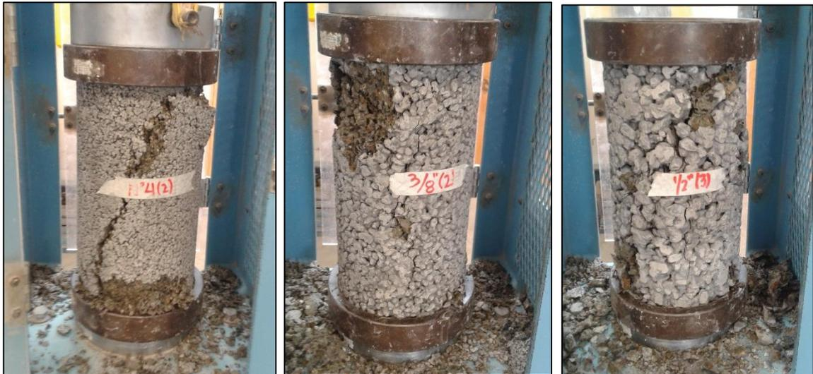
**Figura 44:** Probetas de las tres gradaciones ensayadas a compresión. Fuente: Autor de Tesis.
