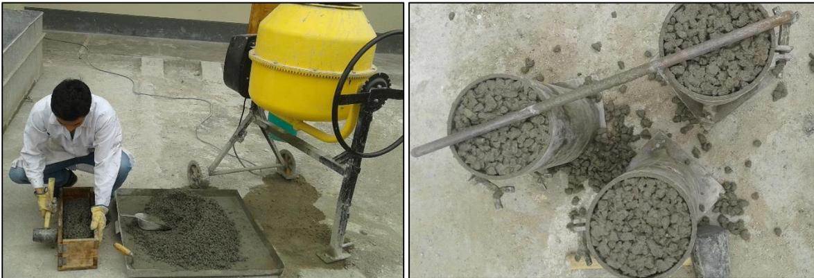
**Figura 41:** Elaboración de probetas para Flexión y Compresión. **Fuente:** Autor de Tesis.
