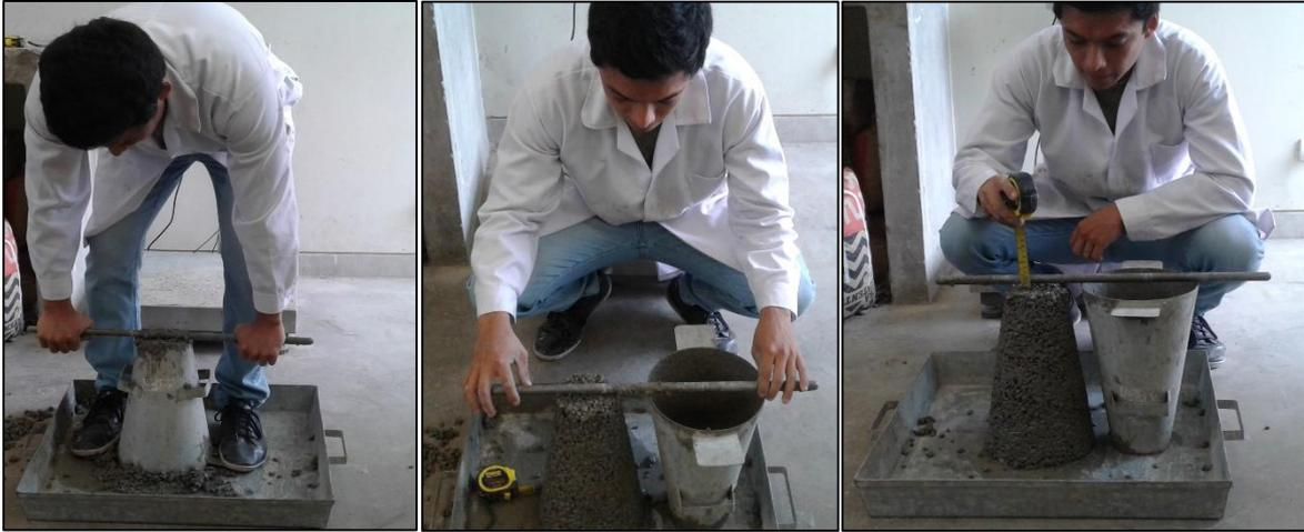
**Figura 40:** Asentamiento del concreto permeable. **Fuente:** Autor de Tesis.
