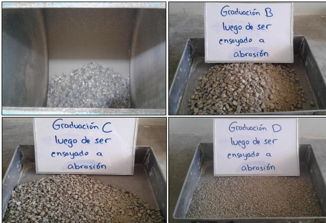
**Figura 39:** Abrasión en la máquina Los Ángeles. **Fuente:** Autor de Tesis.
