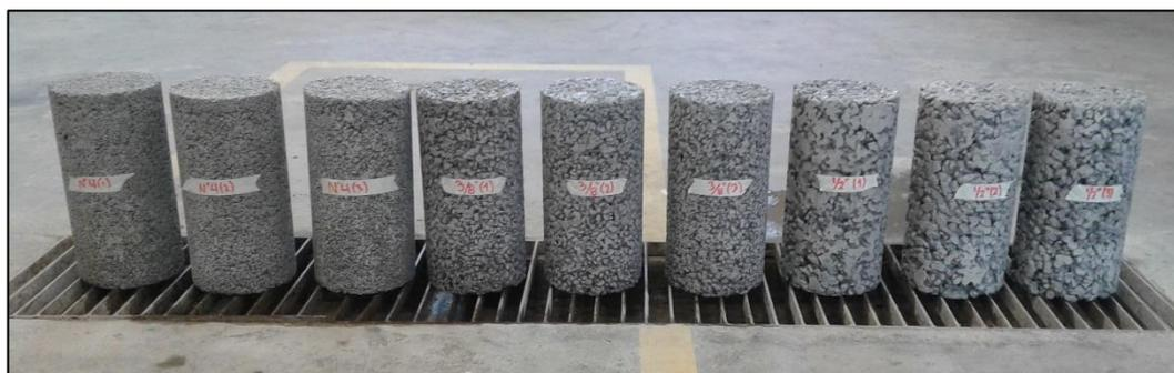
**Figura 6:** Probetas para la prueba de Resistencia a la Compresión a los 28 días. **Fuente:** Autor de Tesis.
