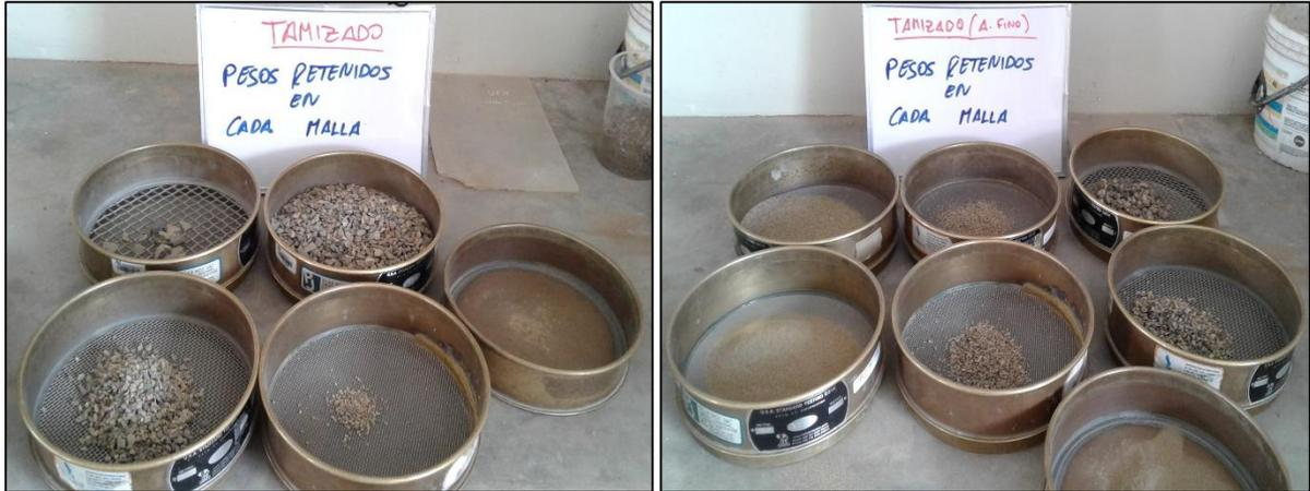
**Figura 32:** Análisis granulométrico del agregado grueso y fino. **Fuente:** Autor de Tesis.
