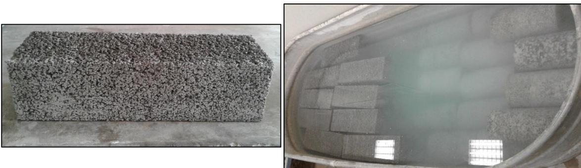
**Figura 42:** Desencofrado y curado de probetas. **Fuente:** Autor de Tesis.
