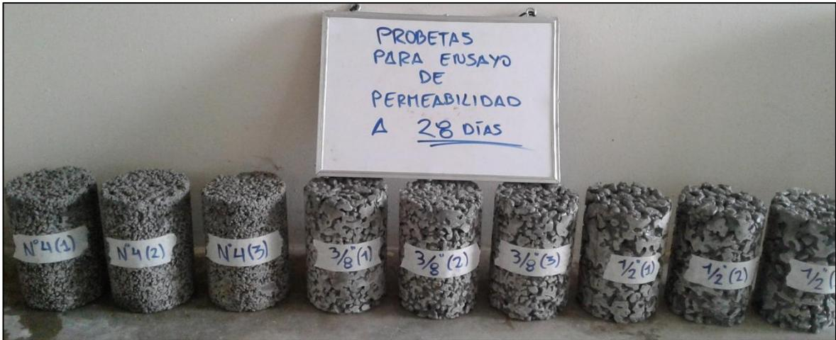
**Figura 46:** Probetas para ensayo de Permeabilidad. **Fuente:** Autor de Tesis.
