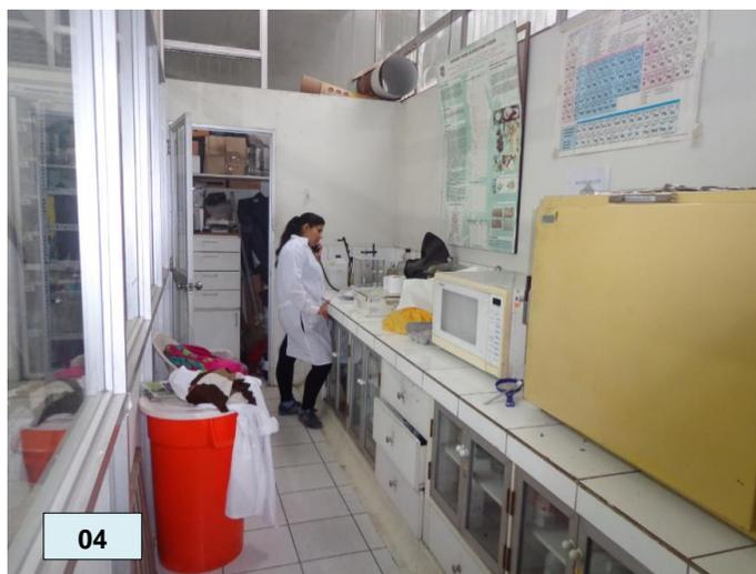
01. Laboratorio de enseñanza: campana extractora o Fume Hood obstruye abrir de puerta de almacén. Tabiquería de albañilería, tarrajeado y pintado, zócalos sanitarios presente.
