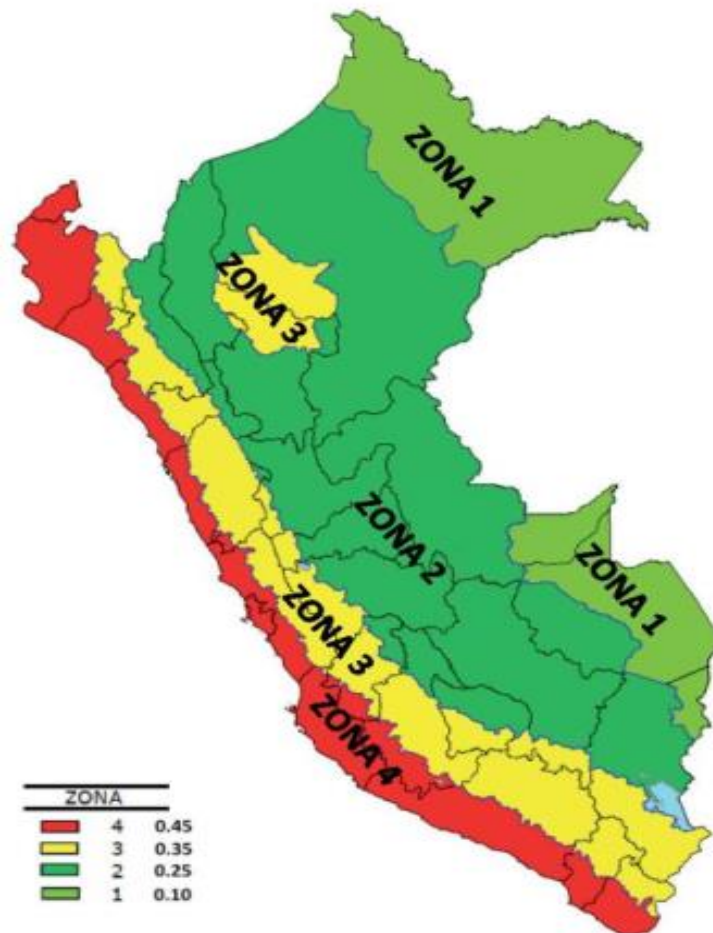
Figura n.º 2. 42. Zonas sísmicas.
