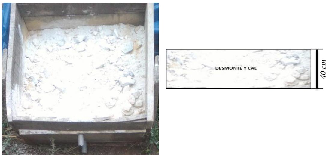
Figura 4. . Réplica del tratamiento CD, con 20 cm de espesor de material de Desmonte con enmiendas de cal.
