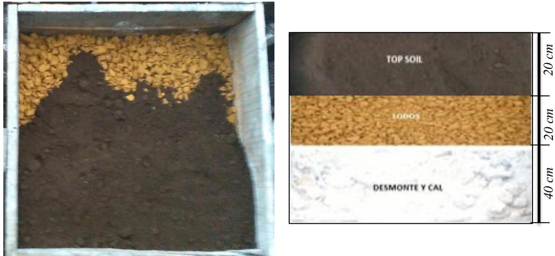
Figura 7. Réplica del tratamiento 2 y distribución de sus capas
