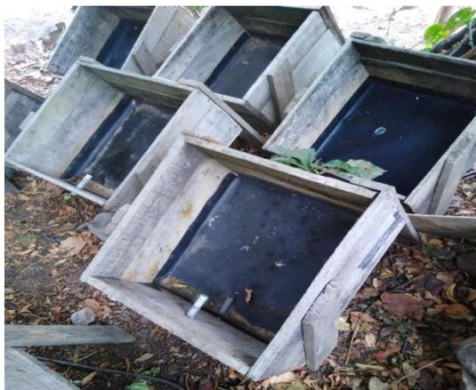
Figura 1. Cajas de madera con base de geomembrana, e inclinación de 30°.
