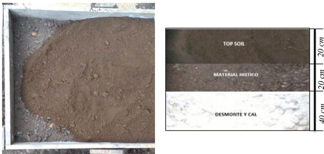
Figura 6. Réplica del tratamiento 1 y distribución de sus capas
