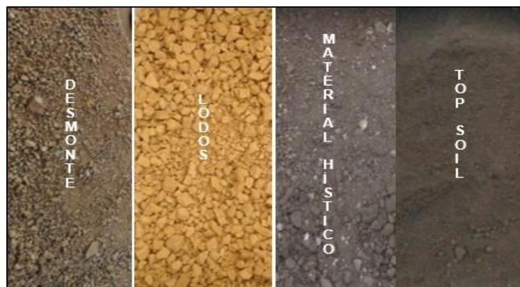
Figura 2. Materiales Usados en los sistemas de coberturas de la investigación
