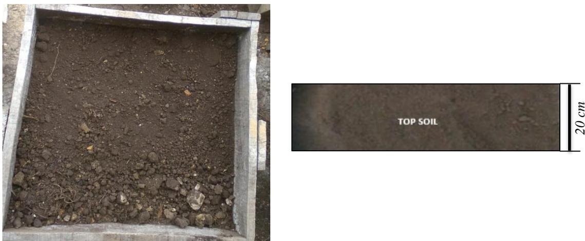
Figura 3. Réplica del tratamiento CT, con 20 cm de espesor de material de Top soil
