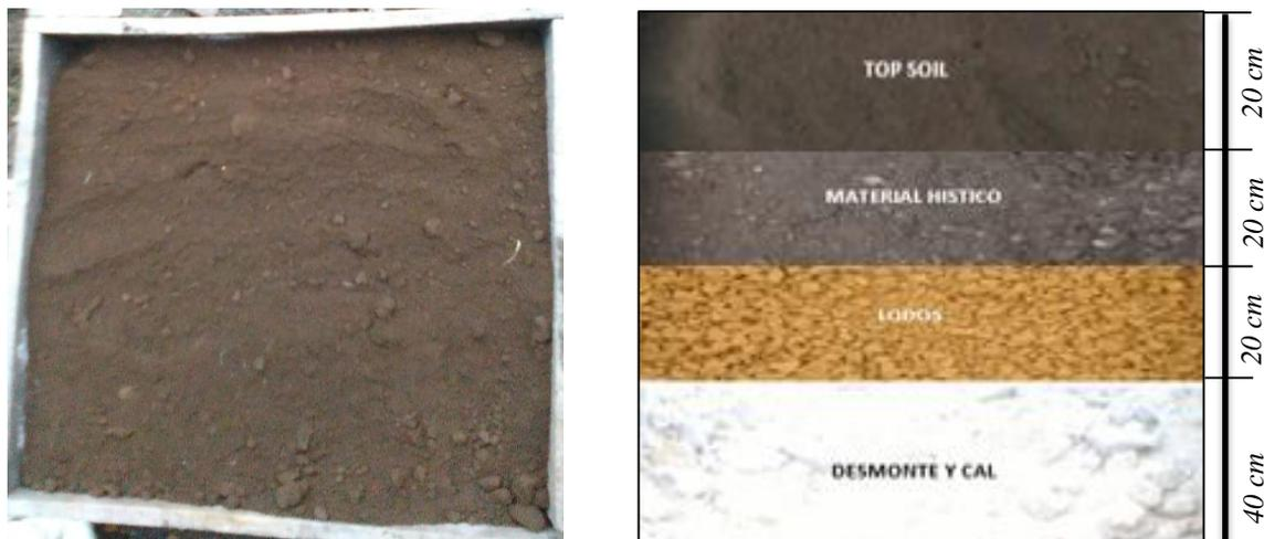
Figura 5. Réplica del tratamiento H y distribución de sus capas
