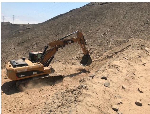
Figura 10. Excavadora sobre orugas modelo CAT 324D que se utilizará en el trabajo.
