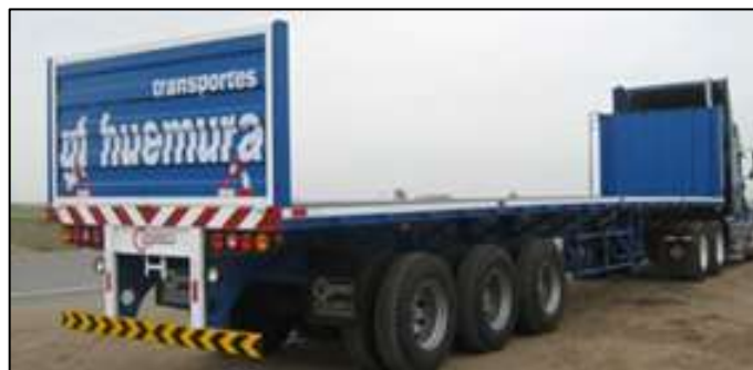
Ilustración 2 Plataforma con capacidad de 48 toneladas
