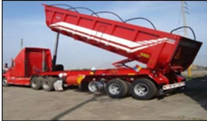
Ilustración 1 Tolva granelera de 48 toneladas
