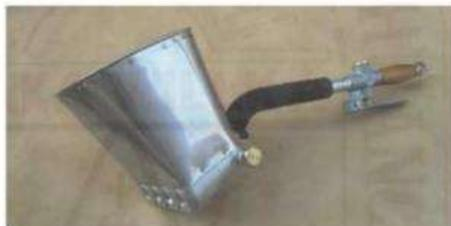
Se recomienda que se realice mediante una revocadora neumática de impulsión. Un obrero que trabaja con una revocadora Emedos (M-2) con un aporte continuo de material cercano, puede llegar a revocar en una hora de trabajo hasta 60 m<sup>2</sup> de pared, con un espesor de revoque de aproximadamente 1 cm.
