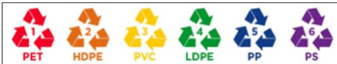
**Figura 01:** Clasificación de plásticos (Defalla, 2016). En la figura se muestra cada uno de los polímeros como el polietileno de tereftalato (PET); polietileno de alta densidad (HDPE); cloruro de polivinilo (PVC); polietileno de baja densidad (LDPE); polipropileno (PP); poliestireno (PS).
