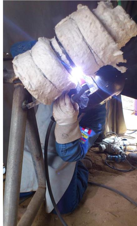
Proceso de calificación de soldadores en posición 6G, según ASME Secc. IX, con temperatura controlada y gas de respaldo. Material PN° 15E.
